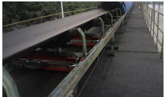
图1:安装在现场工作的MMI电子皮带秤
