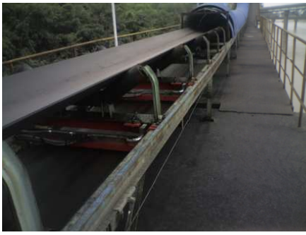
02. 安装在现场工作的MMI 电子皮带秤
