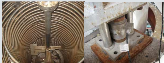
图 6 左为带搅拌器和盘管反应釜内部结构 右为传感器组合安装单元
