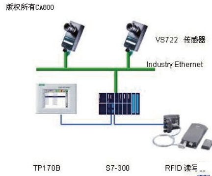
图3: 缸体打刻检查工位控制系统结构图
