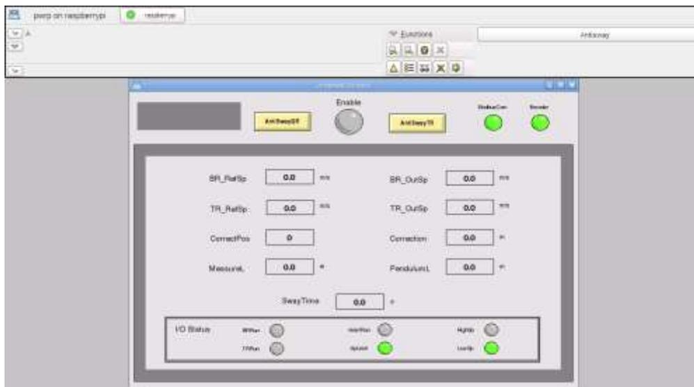
对防摇摆效果影响最主要的参数为加速度，双脉冲防摇摆原理即通过两个短脉冲的加速度相互抵消造成的摇摆现象，如果给定速度一定，加速度过高或过低，都会造成防摇摆效果不理想，因此调整合适的加速度对防摇摆控制模型尤为重要。模型加速度参数为  $amax[0]$  和  $amax[1]$ ，路径为 RTU-AntiSway-W-AntiswayBR-umax- $amax[0]/amax[1]$ 。小车的调整与大车调整方法一样，调整 AntiswayTR 中的  $umax[0]/[1]$  和  $amax[0]/[1]$ 。
