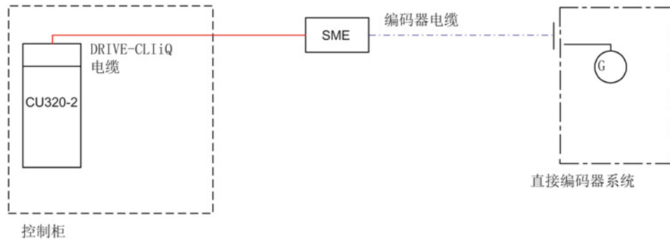
图 8-34 通过外部编码器模块 SME 连接直接编码器系统
