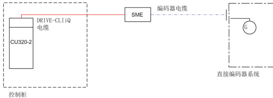
图 8-29 通过外部编码器模块 SME 连接直接编码器系统
