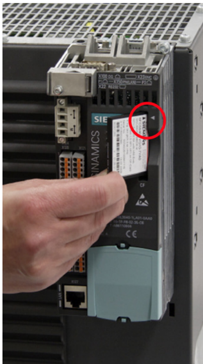
图 7-5 在 CU310-2 PN 中插入存储卡
