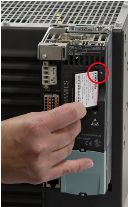
图 7-12 在 CU310-2 DP 中插入存储卡
