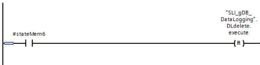
程序段 20：通过使用函数“SLI_FC_deleteEntry_DataLog”删除数据日志的条目。如果参数 DONE (“#deleteDone”) 的信号状态为“TRUE”，则执行删除操作。
