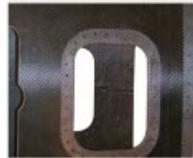
5轴成型以3 m/min进给，主轴11,000 rpm使用16 mm立铣刀，5轴钻孔以1、2 m/min进给，主轴15,000 rpm/10 mm钻头
