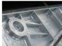
筋壁厚从2.2 mm到4 mm不等，采用20 mm R5锥形立铣刀以6,000 rpm和3 m/min的进给进行铣削
