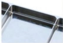
平面和薄壁之间的半径铣削采用8 m/min进给的5轴步进循环，主轴15,000 rpm使用16 mm R2外圆角立铣刀
