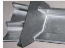
筋壁厚2.5 mm，采用12 mm R6立铣刀以6,000 rpm和3 m/min的进给进行铣削
