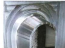
锥形壁面采用5轴轮廓铣削精加工，进给6 m/min，主轴1,300 rpm使用16 mm立铣刀
