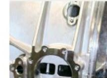
攻丝用3+2轴加工以2 m/min进给，主轴750 rpm使用8 mm的专用铣刀
