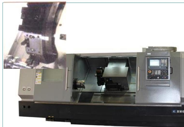
结构上采取后置刀架、斜床身，一般采用半闭环或者全闭环。在硬件上，配置分度装置、铣削动力头等，具备XYZC等轴控制，实现多工序的加工的机床，在工件一次装夹后，它可完成回转类零件的车、铣、钻、铰、攻螺纹等多种加工工序，其功能全面，但价格较高。
