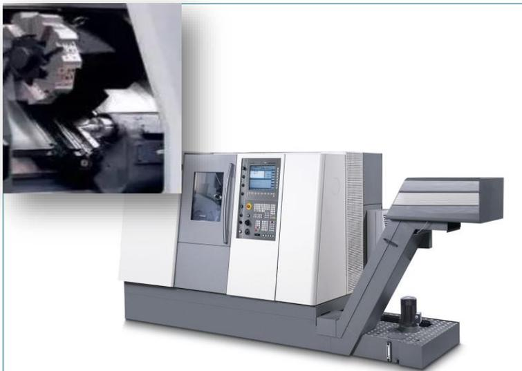
结构上一般是后置刀架，斜床身，具有高刚度、高精度和效率等特点一般采用半闭环控制系统。以卧式车床为例，一般含有2个移动轴X轴和Z轴，还可以另配一个分度轴C轴。
