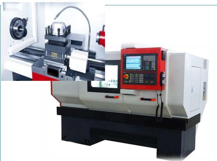
结构上基于普通车床，采用前置刀架，刚性相对较差。控制方面一般采用半闭环系统（也有一些开环伺服系统），此类车床结构一般是在普通车床的基础上发展起来，结构简单，价格低廉。
