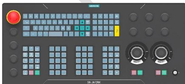
SINUMERIK ONE MCP 2400 采用了模块化设计，MCP 的标准键盘可以通过 USB 电缆直接连接 IPC、TCU、ITC 显示屏，并且 MCP 可以通过 IE 或 PROFINET（本测试样例采用 IE MCP）两种通讯方式通讯连接至系统，在调试 MCP 之前需要首先了解 MCP 的组成。它通常由三部分组成：通讯模块、控制模块、手轮模块。
