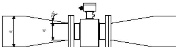
通过缩小管道的流通面积，可在大管道中安装一个较小的传感器。这样有利于提高传感器内小流量的速度并且因此达到一个较高的测量精度。
