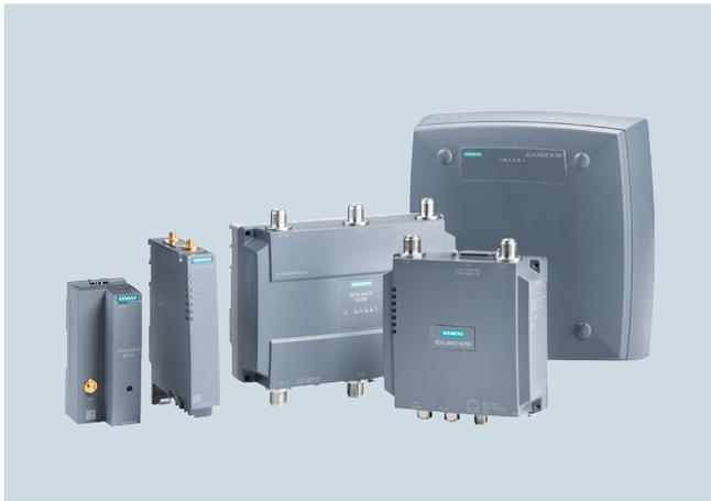
SCALANCE W700 产品线的接入点非常适合建立 2.4GHz 或 5GHz 的工业无线局域网 (IWLAN)。产品可以用于需要较高使用可靠性的场合，特别是极端环境下的所有应用：
