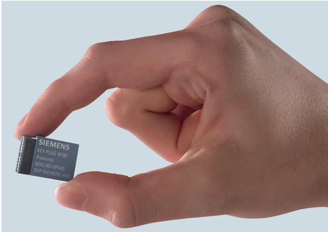
用于激活 iFeatures 的交换介质卡，用于快速更换发生故障的设备，储存配置数据；可用于带有 PLUG 插槽的 SCALANCE W 接入点或者客户端。若设备出现故障，它能在没有 PG 的情况下用 SCALANCE 配件进行设备替换。可用于带有 K-PLUG 插槽的 SCALANCE W700 IEEE802.11n 产品也可用于数据配置的自动化备份。
