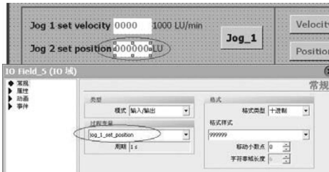
变量 jog\_1\_set\_position 关联到 S120 中 Drive\_1 的 p2587 (EPOS jog1 traversing distance)。双击输入 / 输出框，在“常规 -> 过程变量”项中关联变量 jog\_1\_set\_position，从而可以通过 HMI 给定 S120 中 jog 的位置设定。
