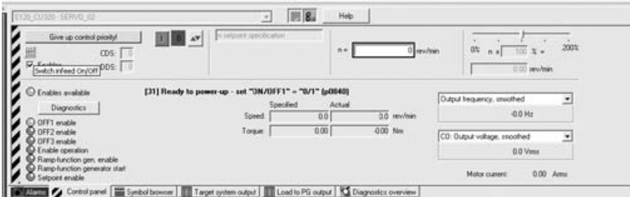
注意，如果采用ALM、BLM或者是16 kW以上(包含16 kW)的SLM模块，在使能驱动之前，要先激活整流单元infeed模块，如下图所示：
