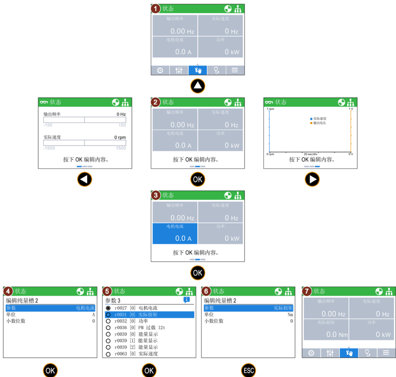
图 5-2 选择和修改 IOP-2 状态屏幕
