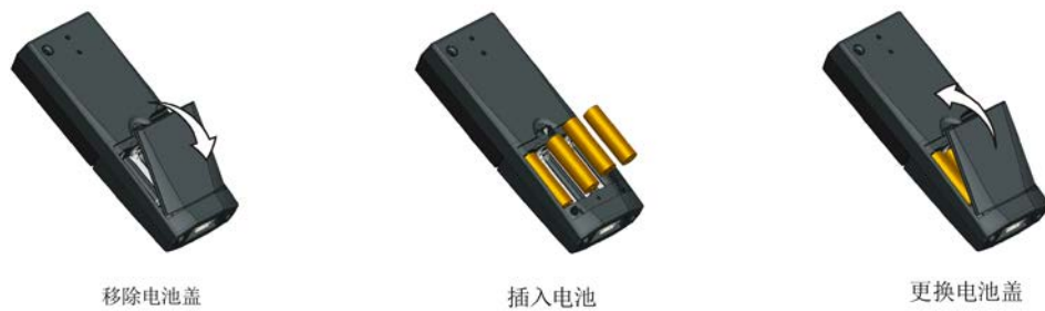
图 9-4 安装手持套件的电池
