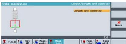
使用校正探头功能自动测量刀具长度和刀具直径。
