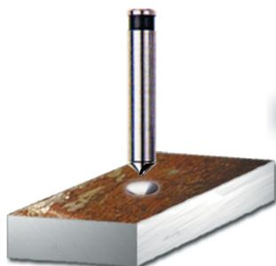
NC 点钻：用于后续钻削时定位孔心和加工倒角。若您规定了倒角外径，ShopMill 会自动计算深度值。
