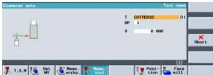
使用直径自动功能用刀具量规测量刀具直径。
