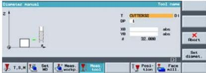
使用直径手动功能测量刀具直径。
