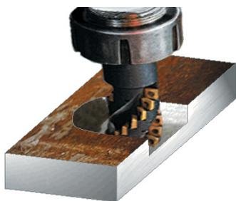
插入式轴铣刀：一种多头刀具，它将刀具螺旋式排列起来，以产生一种特殊的“平滑”机械加工效果。
