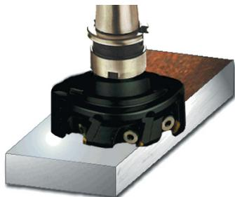
端面铣刀（亦称为旋转刀片）：用于清除较多的材料。
