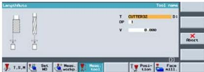
使用长度自动功能用刀具量规测量刀具长度。
