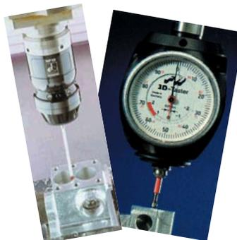
可以使用电子式和机械式 3D 探头。电子探头的信号可以直接由控制器进行处理。
