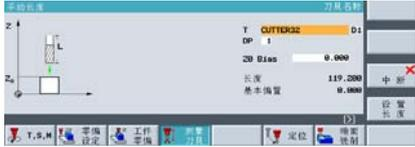
使用长度手动功能在 Z 轴方向上测量刀具。
