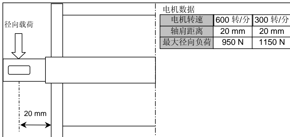
图 2-9 步进电机径向载荷
