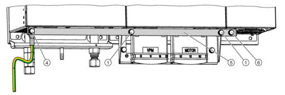
Figure 4-17 Installing the equipotential bonding bar
