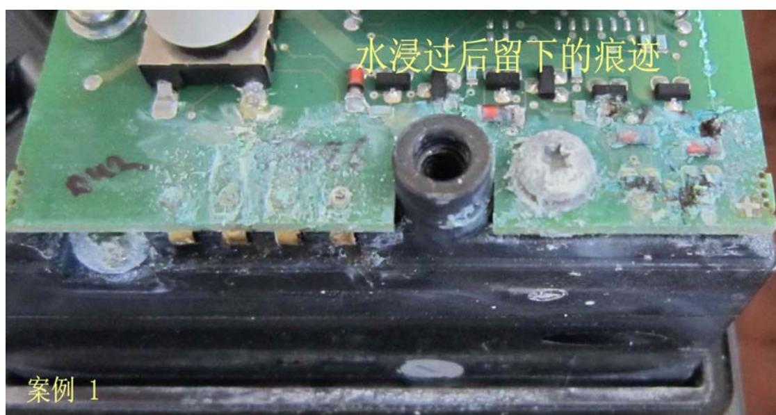
雨水集聚在定位器盒内成了水罐，电路板被浸泡的痕迹；
