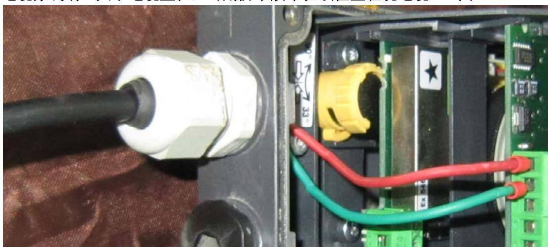
拧紧电缆端口螺帽, 密闭端口的缝隙。
