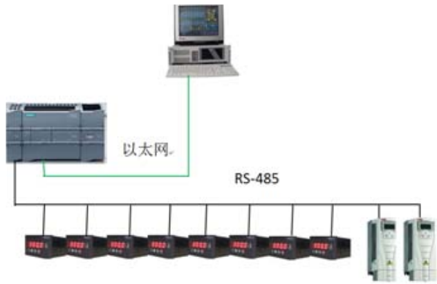
图 1 换热站数据采集以及远程传送系统图
