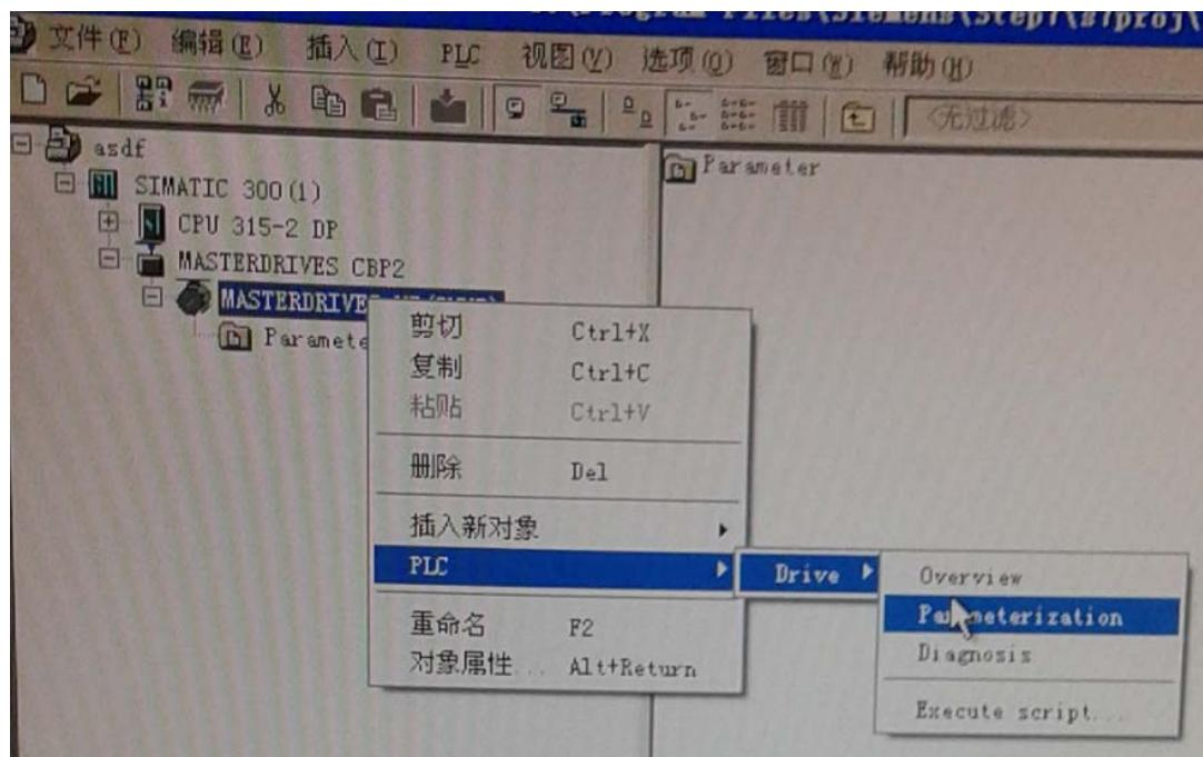
步骤五：通过步骤四可以打开 DRIVER MONITOR 软件，然后按照“File---upload---basic device complete”上传变频器整体参数，完成变频器参数备份。
