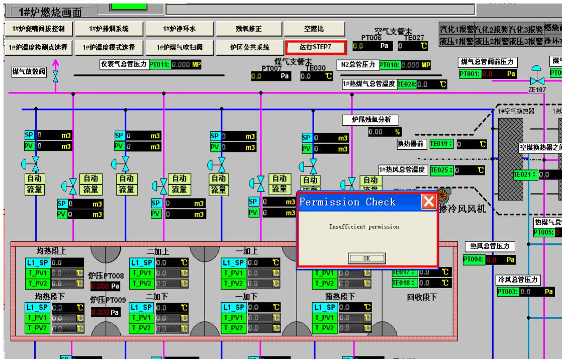
按下 **Ctrl+A**，调出登陆框；填写有效用户名和密码后，成功登陆后，点击“运行 STEP7”按钮，会打开 SIMATIC Manager 软件，就可以修改程序了；
