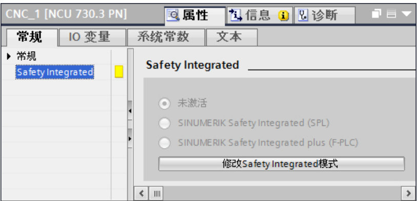
图 6-9 NCU Safety Integrated 设置默认“未激活”。
