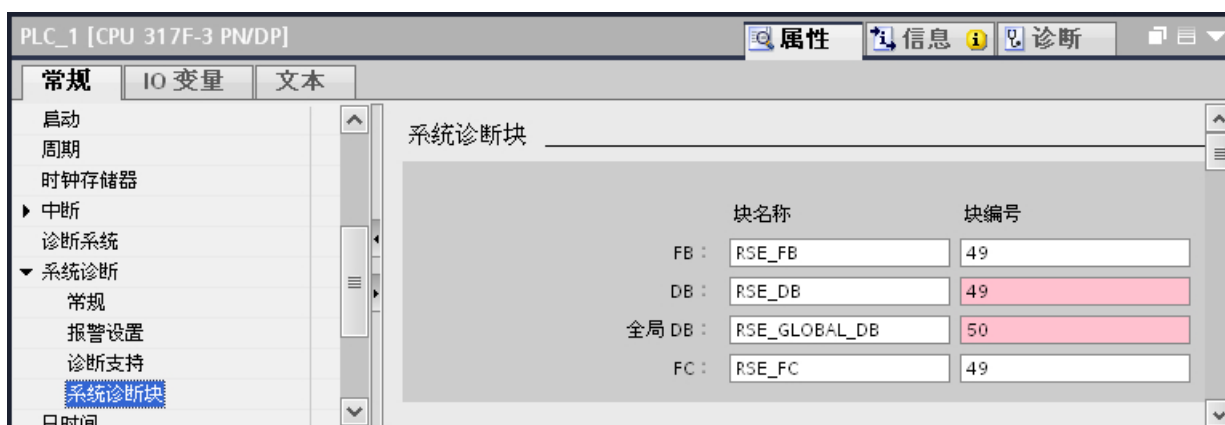
图 6-5 系统诊断块的缺省编号已被占用
