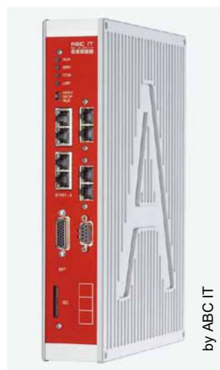
图 3: 紧凑型 ABC X-CPU-2 e57, S5 升级成 S7 后, 把 CPU 模块嵌入配套的外盒 e57
