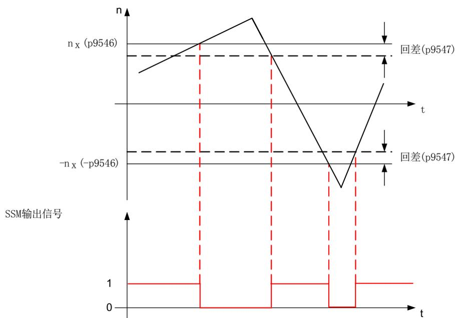
图 4-12 回差使能后 SSM 的安全输出信号
