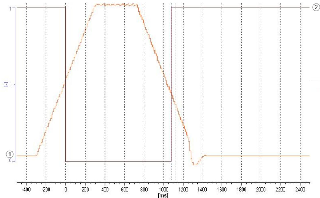
① 驱动\_1.r9714[0]: SI Motion 诊断速度，控制单元上的负载侧速度实际值
