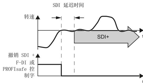
您可以通过 2 个故障安全信号（F-DI 或 PROFIsafe）禁止正旋转方向或负旋转方向。
