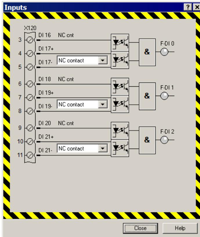
图 6-8 用于控制 Extended/Advanced Functions 的 F-DI 的配置窗口
