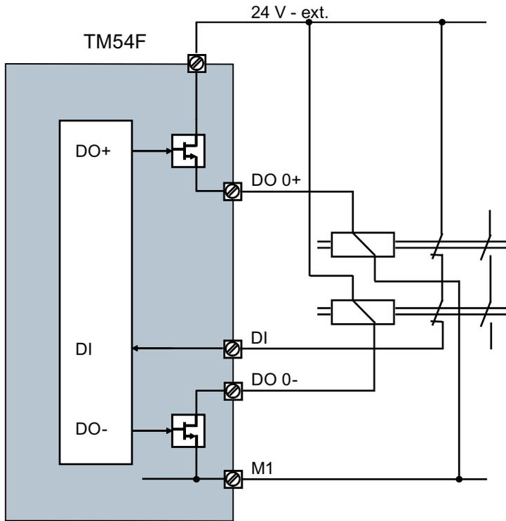
图 6-22 F-DO 回路的“检查模式 2：F-DO 在 DI 中回读（继电器回路）”
