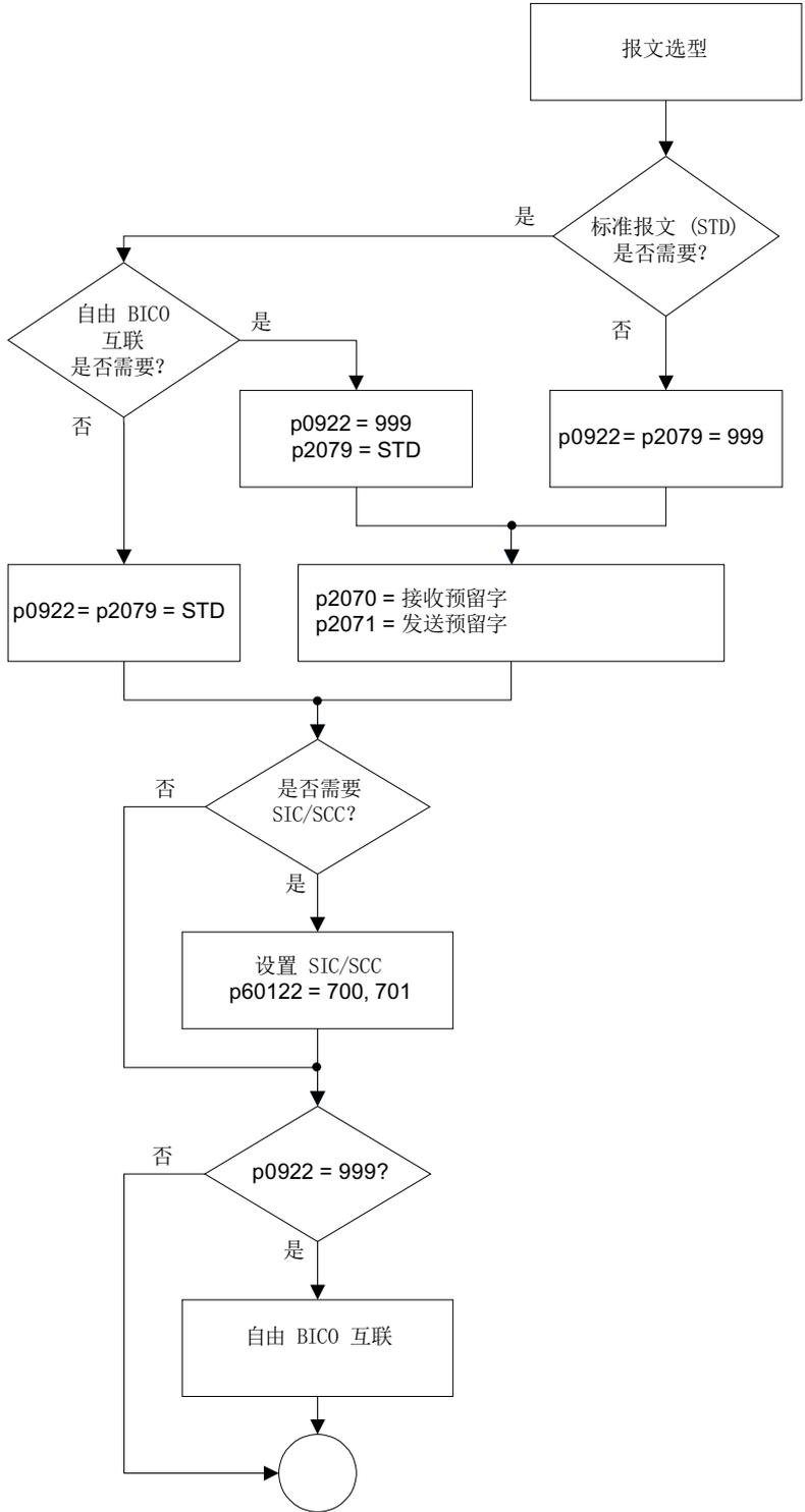
图 5-11 在 STARTER 中配置报文的步骤
