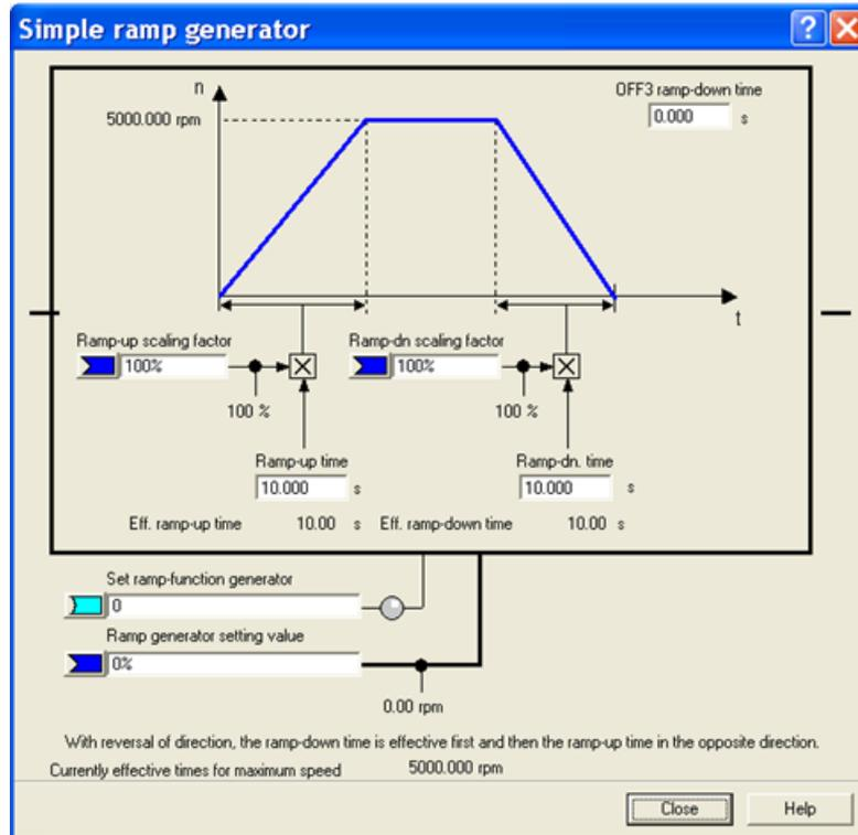
图 6-3 斜坡函数发生器的斜坡
