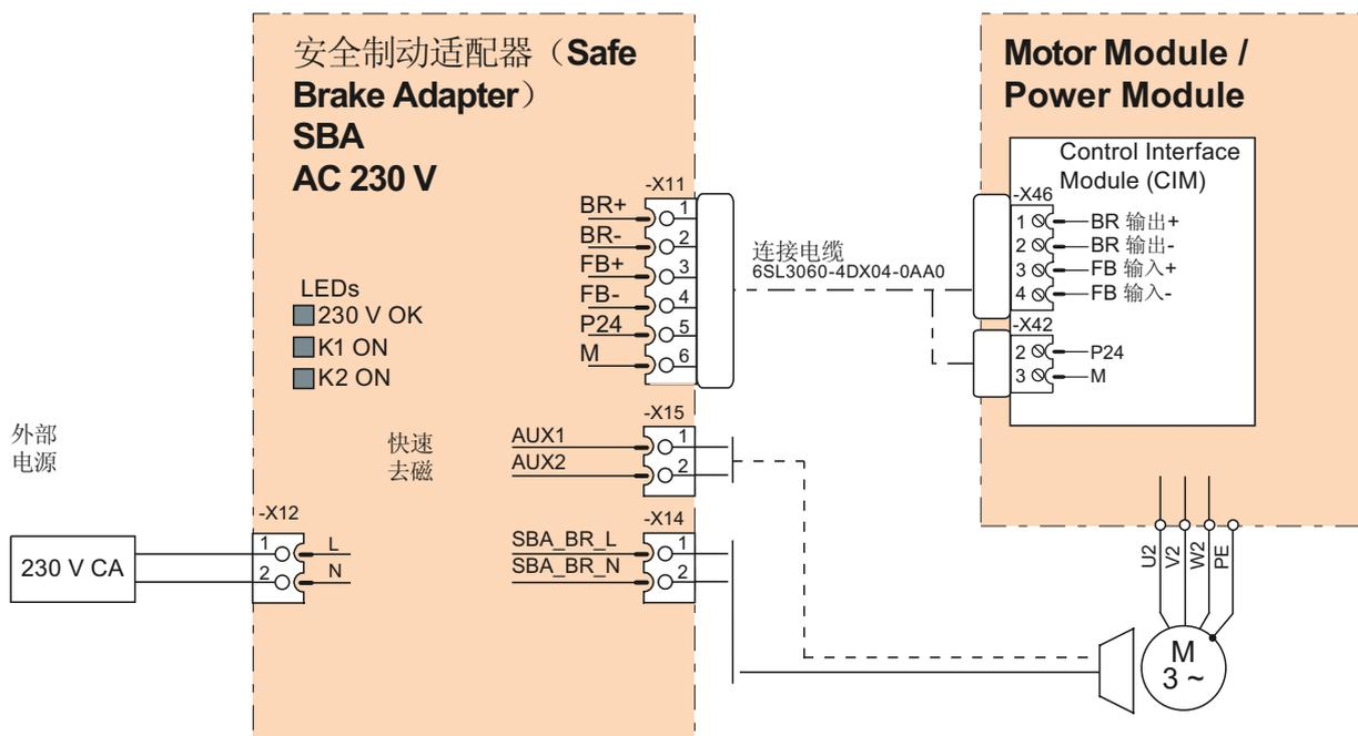
图 4-4 安全制动适配器接线图
