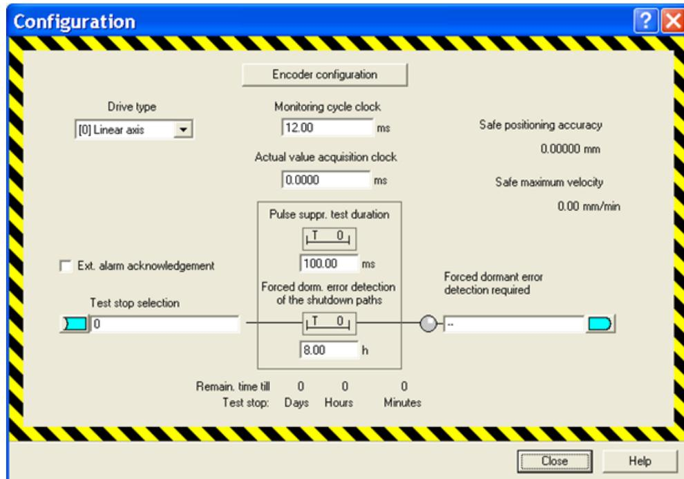
图 6-48 安全配置：驱动器
