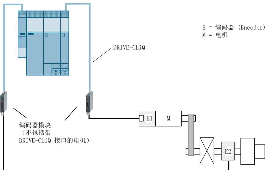
图 4-21 示例：回转轴上的双编码器系统
