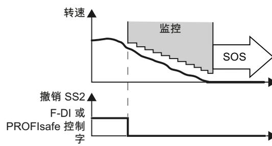
电机在转矩控制中运行时，一旦选中 SS2 变频器便从转矩控制切换到转速控制。
