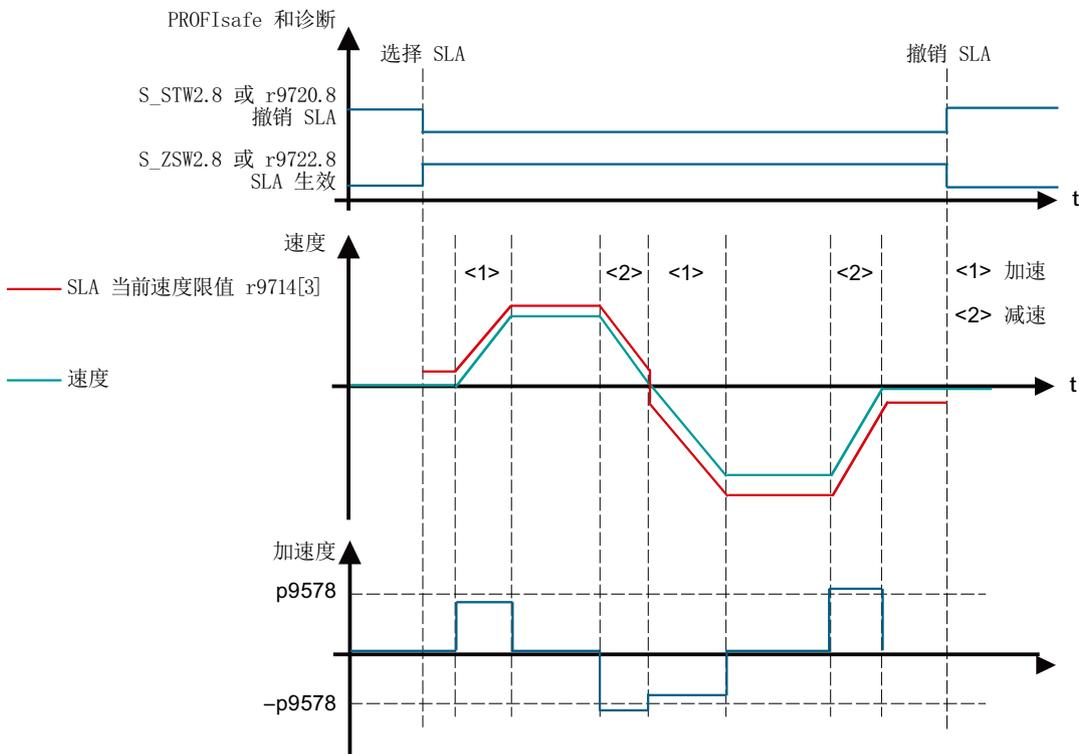
图 4-16 Safely-Limited Acceleration (SLA): 原理
