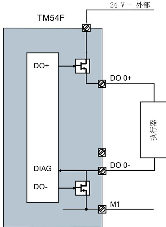
图 6-21 F-DO 回路“强制检查模式 1: 内部诊断信号检测（被动负载）”
