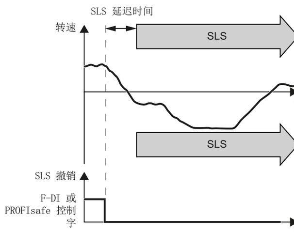
此外 SLS 中提供的设定值限值可在斜坡函数发生器中配置为最大转速。该条件下通过 SLS 限制转速设定值。
