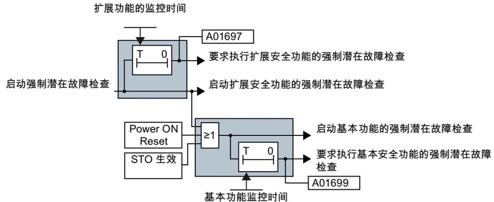
图 6-1 变频器上定期强制潜在故障检查 (Teststop) 的监控方式
