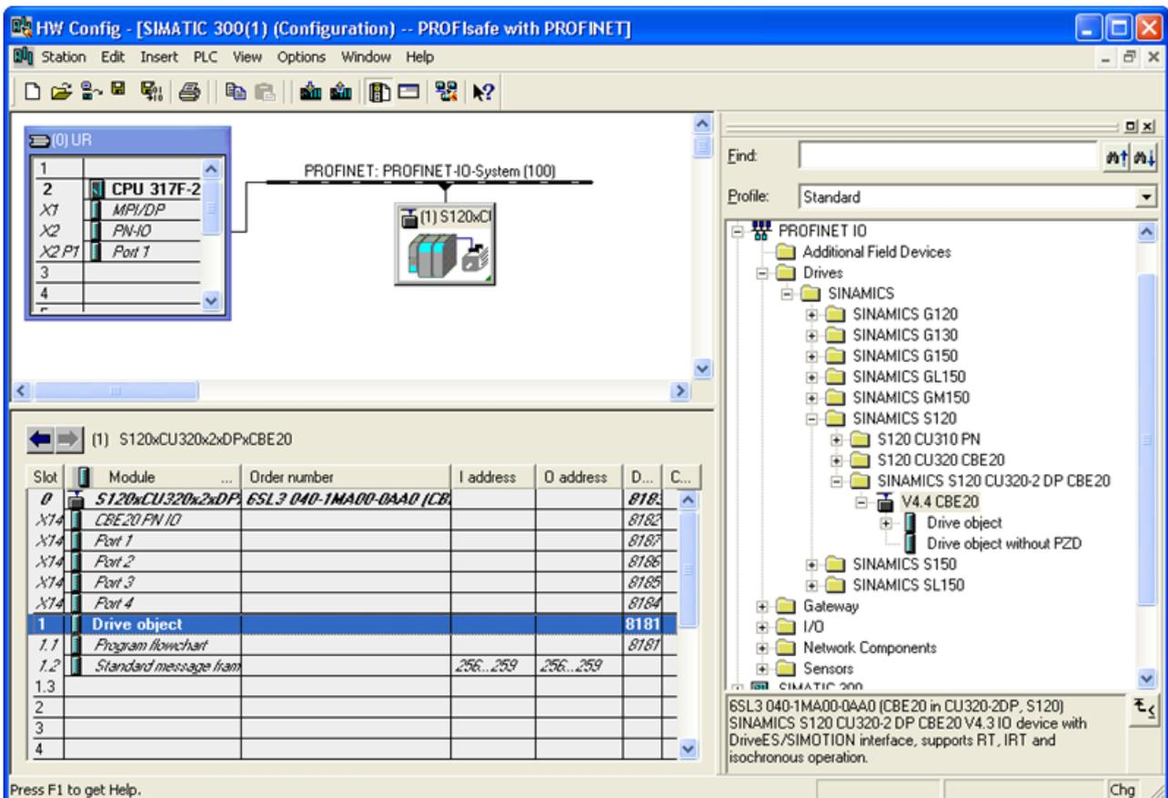
图 6-39 HW Config 中的 PROFINET 配置窗口
