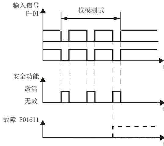
图 5-4 变频器对位模测试作出响应
