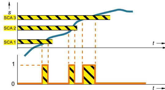
当驱动位于指定的位置区域时，“Safe Cam”（安全凸轮）功能能输出安全信号。借助此功能可以实现每根轴的安全范围检测。
