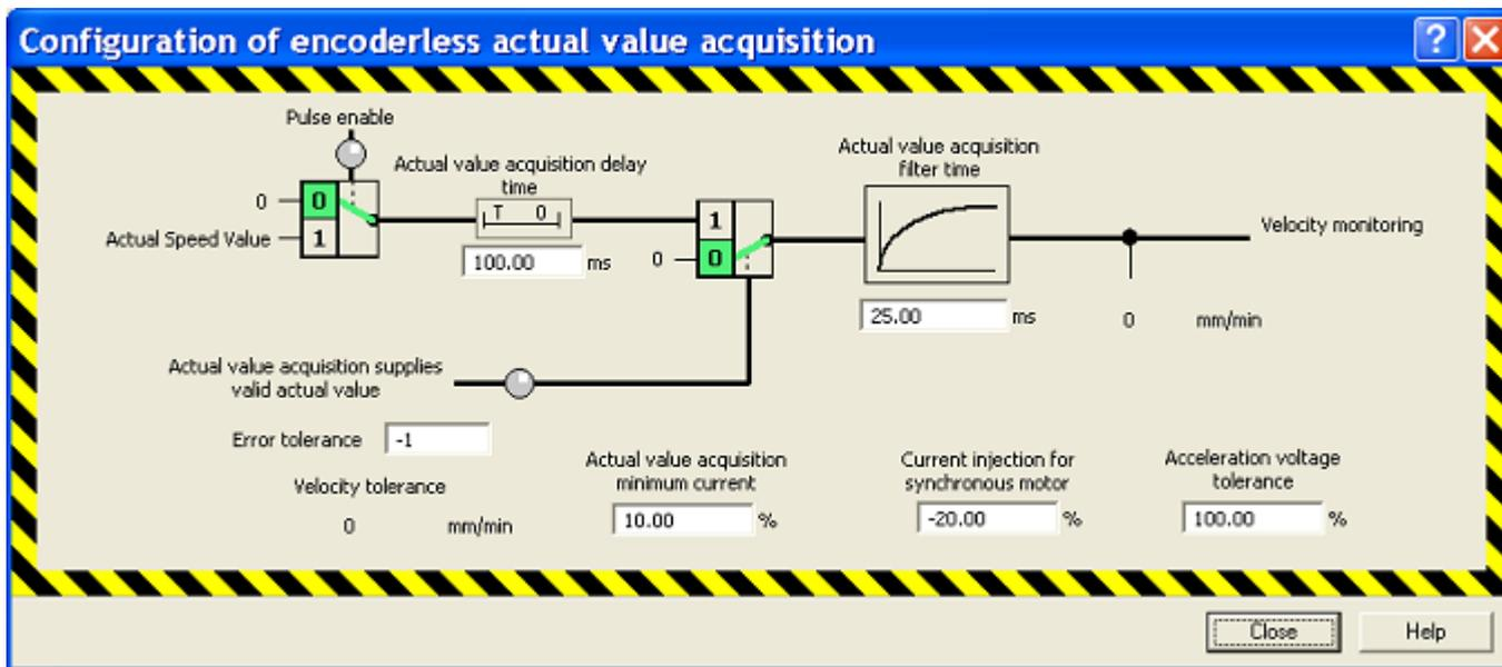
图 4-23 配置不带编码器的实际值检测
