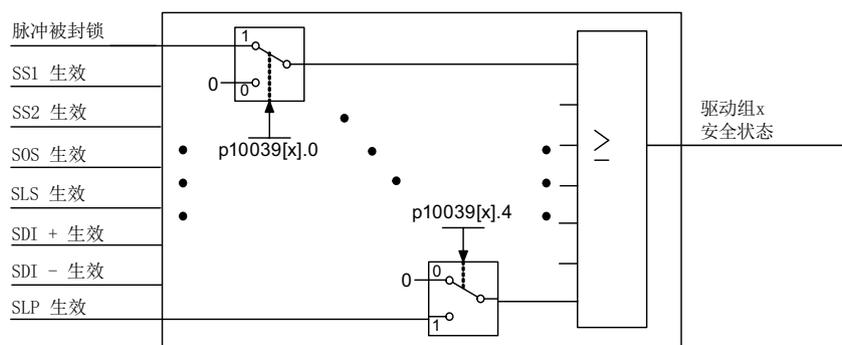
图 5-7 选择安全状态（Extended/Advanced Functions 示例）
