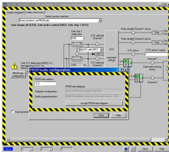
图 6-34 STARTER 中的 Safety Integrated 配置窗口：设置 PROFIBUS 地址（示例）
