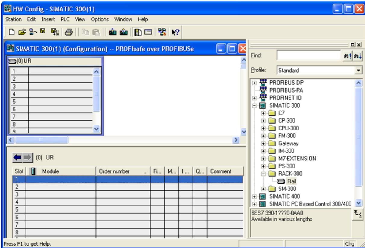
图 6-28 创建型材导轨
