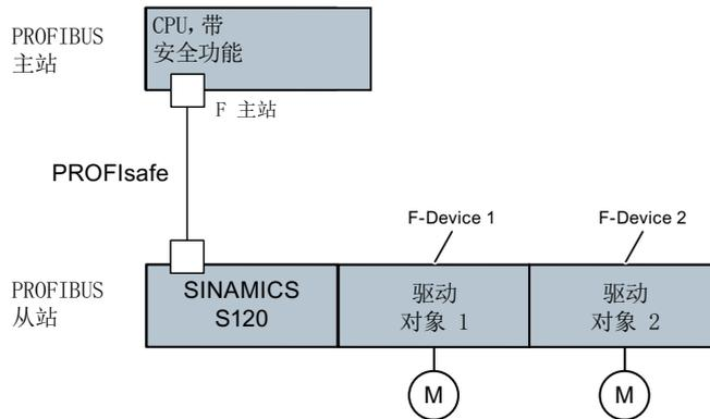
图 6-24 PROFIsafe 拓扑结构示例
