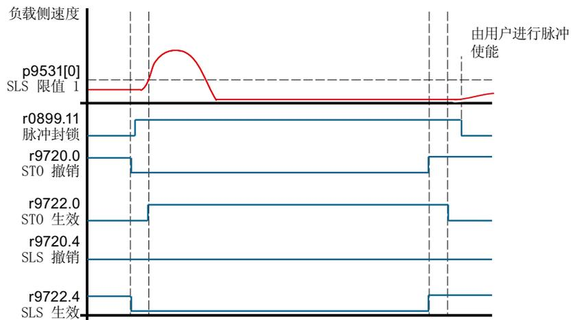
图 4-10 信号图：在外部 STOP A 生效时取消激活 SLS
