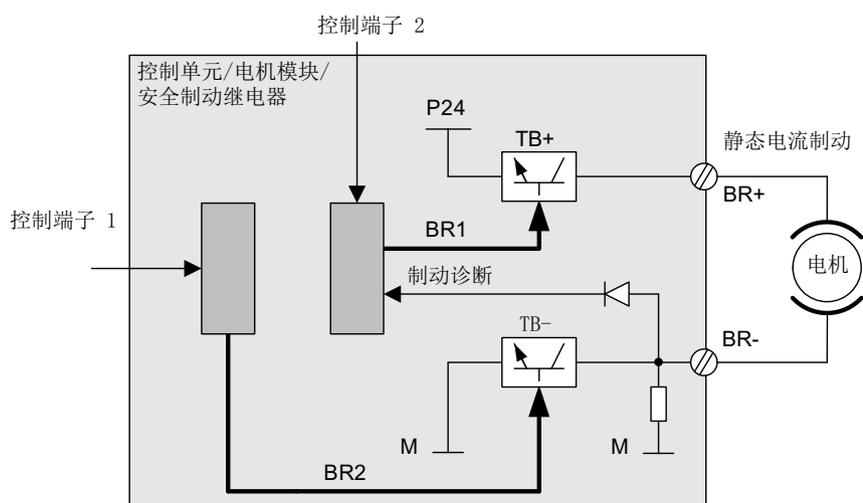
图 4-2 双通道式制动控制 模块型（示例）
