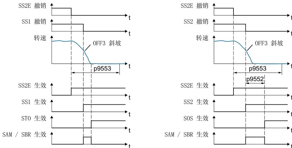
图 4-9 通过功能 SS1（左图）和 SS2（右图）中断功能 SS2E。
