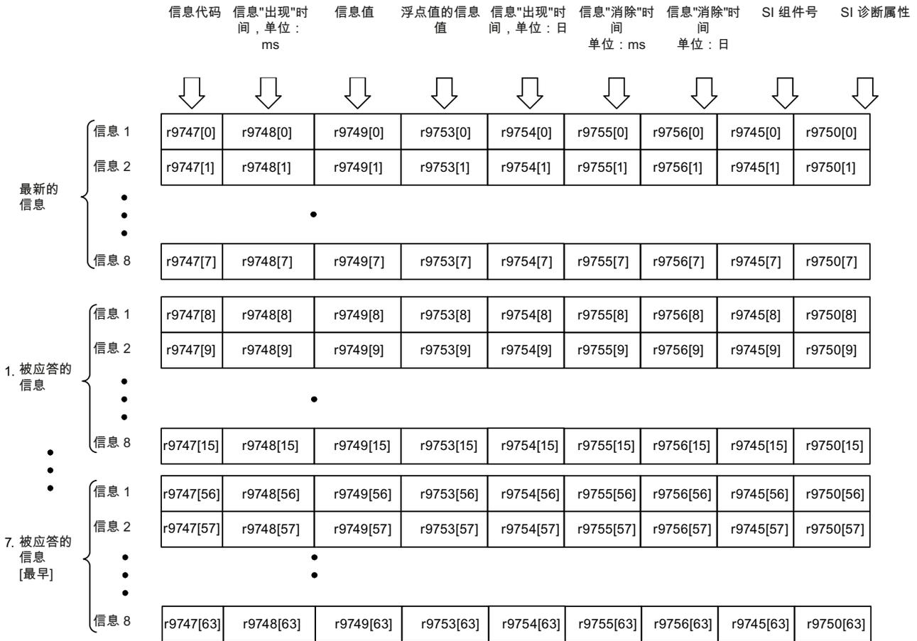
图 9-1 安全信息缓冲器的结构
