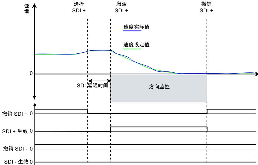
图 4-14 带编码器的 SDI 的工作原理
