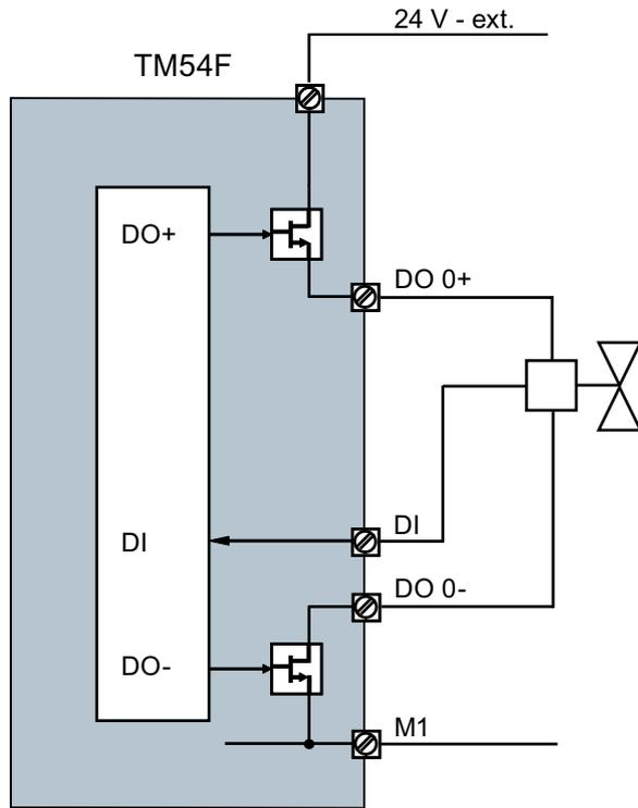
图 6-23 F-DO 回路“强制检查模式 3: 在 DI 中回读 F-DO (执行器反馈)”
