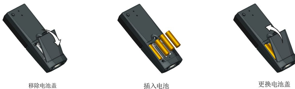
图 9-5 安装手持套件的电池
