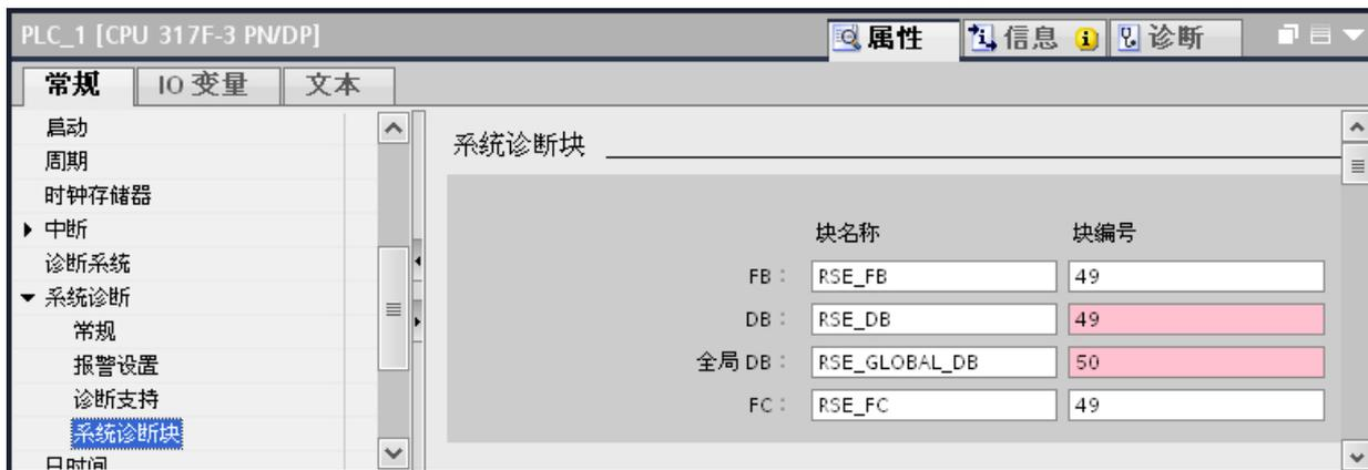
图 7-5 系统诊断块的缺省编号已被占用
