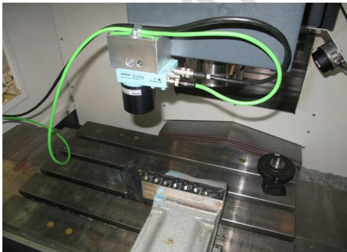
图 1 机床上安装 MV440 测量
