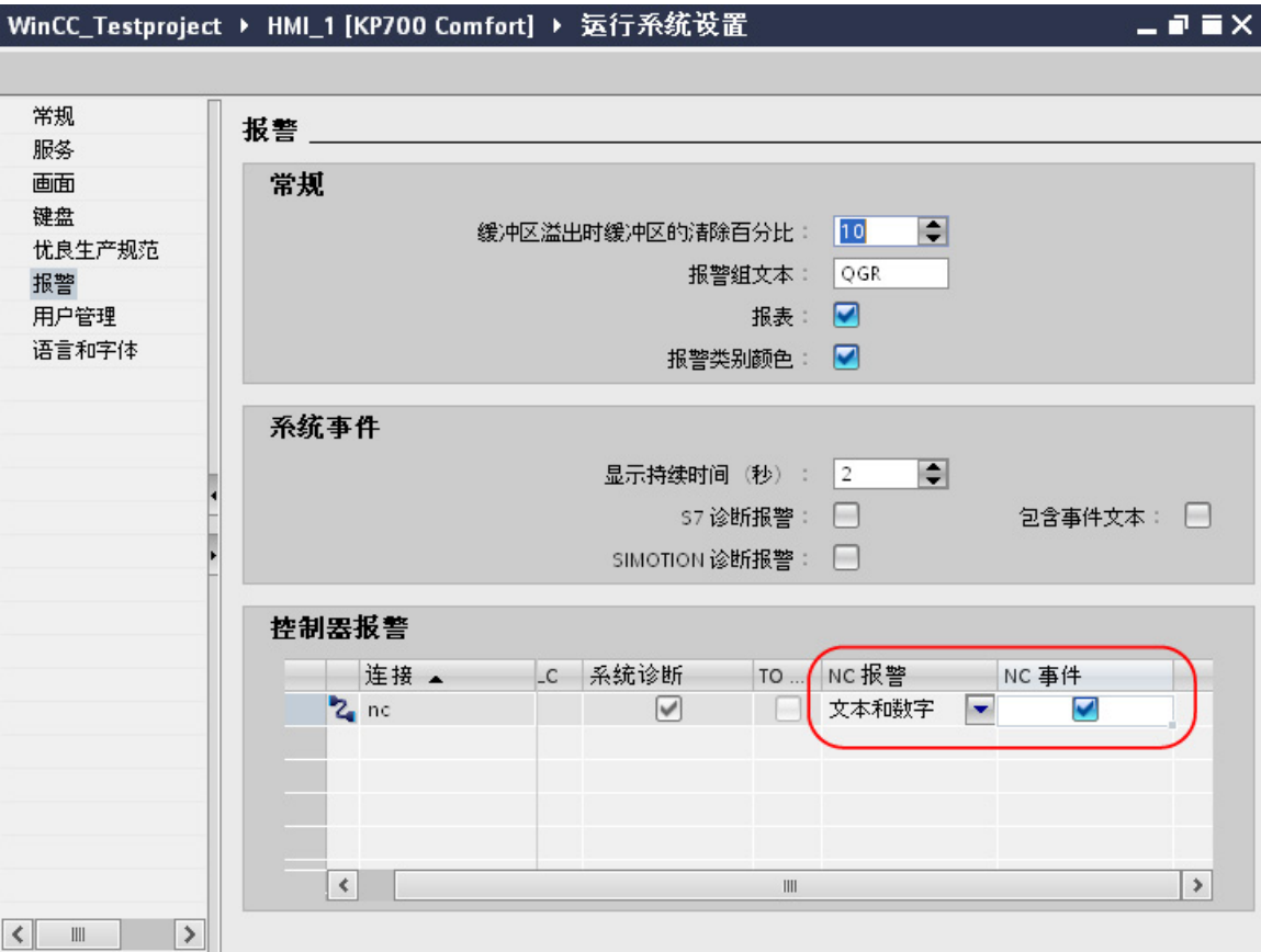
图 7-1 连接的PLC报警设置（屏幕中连接的名称为“nc”）
