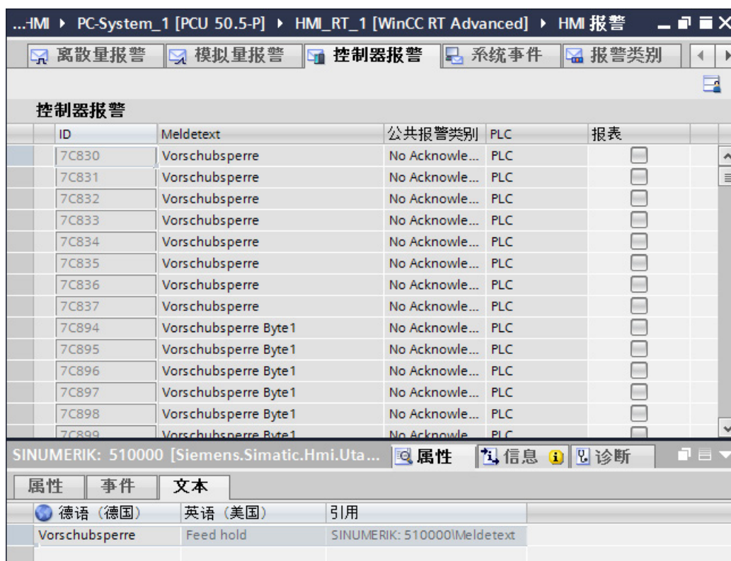
图 7-10 HMI信息编辑器中被导入的DB2报警
