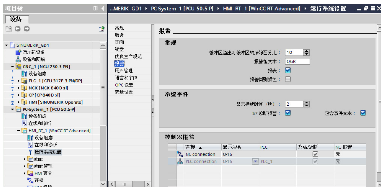
图 7-3 DB2报警的显示设置
