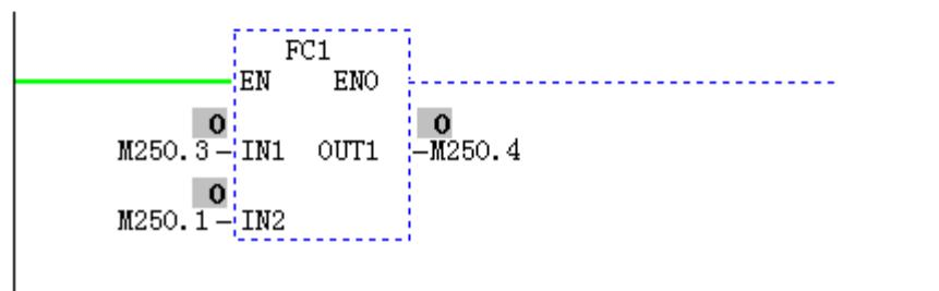
如图: M250.0 有输入时, M250.2 输出为 1; M250.3 没有输入, M250.4 输出为 0.
