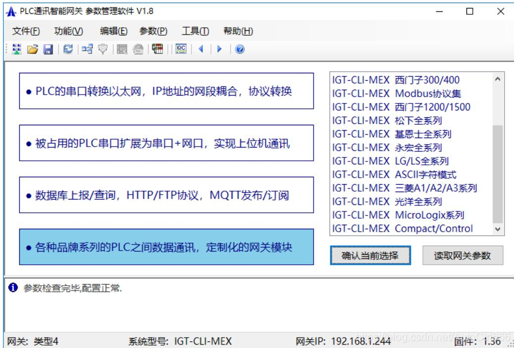
重启后设置网关模块的网口参数，AB PLC的IP地址为192.168.1.9，S7-1500的IP地址为192.168.2.111，不在同一个网段，分别接入网关的两个网口。网口1的IP地址默认是192.168.1.244，网口2的IP地址是192.168.2.244，可以都用默认IP，网口1接AB的PLC，网口2接S7-1500。
