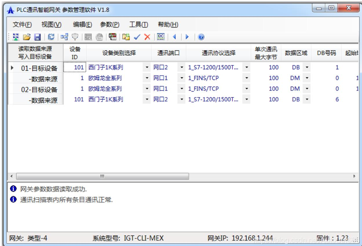
然后就可进行数据测试了，首先在 CJ2M 的 PLC 内设置几个数值，通过博图软件监视 DB1 的数据，直接拔掉接到网关上的网线，将笔记本的 IP 改到 2 网段，如下图：
