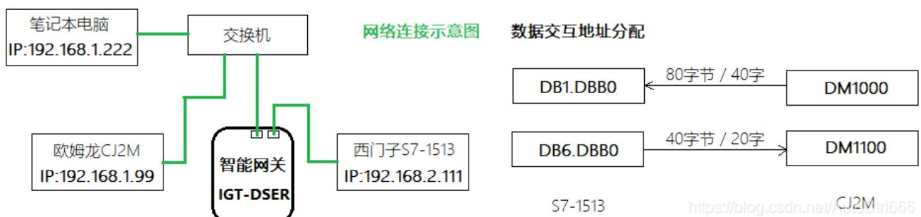
为了便于配置网关参数，将网关、欧姆龙 PLC 和笔记本用交换机连接，设置完成后可不用交换机，网关的两个网口直接与 PLC 连接即可，如下图：
