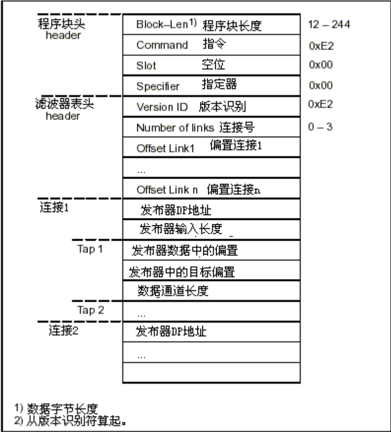
图 5-32 在参数化报文 (SetPrm) 中的滤波器程序段
