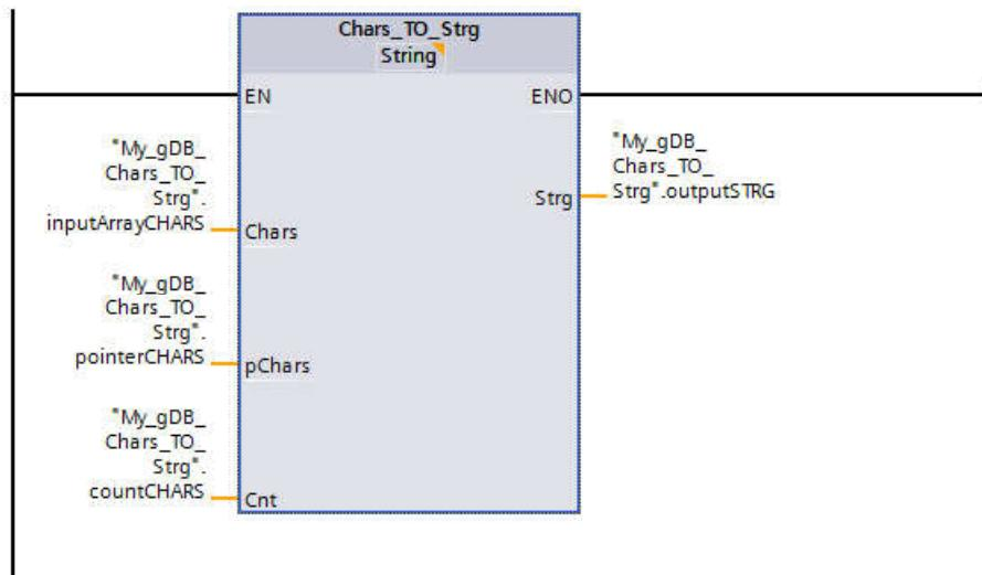
CHARS 结构 ( “inputArrayCHARS” ) 的长度为 10 个字符 (Array ... [0..9])。根据参数 PCHARS ( “pointerCHARS” ) 的值“2”，从该结构的从第三个位置处开始将字符复制到字符串中 ( “outputSTRG” )。从位置“2”开始，结构中的所有字符 ( “inputArrayCHARS” ) 都将复制到字符串 ( “outputSTRG” )，因为参数 CNT ( “countCHARS” ) 的值为“0”。
