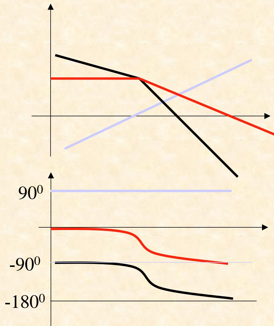
微分控制可以增大截止频率和相角裕度，减小超调量和调节时间，提高系统的快速性和平稳性。但单纯微分控制会放大高频扰动，通常不单独使用。
