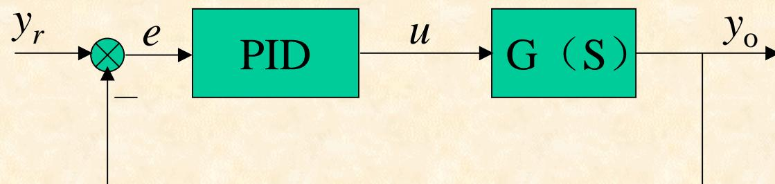
PID控制器的输入输出关系为：
