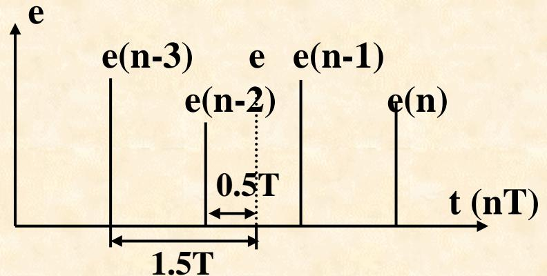
$$\begin{aligned}\frac{\Delta \bar{e}(n)}{T} &= \\ \frac{e(n) - e}{1.5T} + \frac{e(n-1) - e}{0.5T} + \frac{e - e(n-2)}{0.5T} + \frac{e - e(n-3)}{1.5T} \\ &\quad 4\end{aligned}$$
