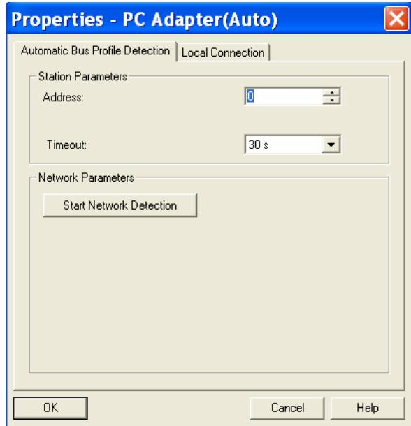
点击 **Start Network Detection** 按钮, Step7 软件会自动检测 CPU 端口的设置, 通过此功能还可以判断 Step7 是否能和 CPU 建立通讯, 具体画面显示如下:
