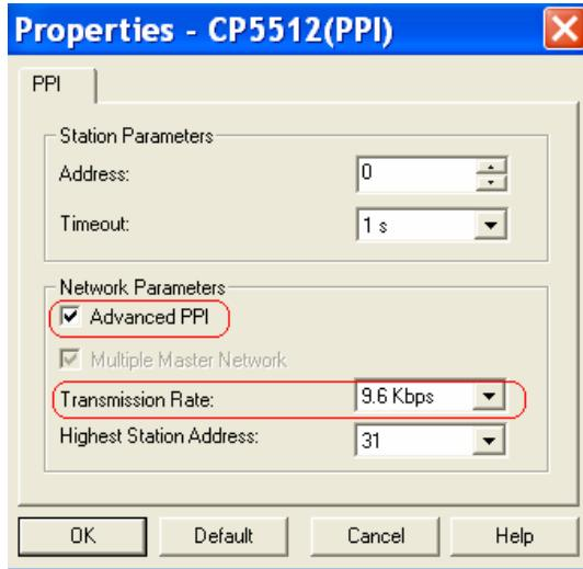
设置 PPI 属性，如果要实现多主站连接，请选中“Advanced PPI”选项，然后选择 PPI 接口的通讯波特率 **Transmission Rate: 9.6 Kbps**，**注意此处的波特率一定要和实际要通讯的 CPU PPI 口实际的波特率相同**，例如如果 CPU PPI 口实际的波特率为 9.6Kbps，而此处设置为 187.5Kbps，则不能建立通讯，会显示错误信息，其它按默认设置，**同时要注意 PG/PC 的地址不要和 PLC 的地址相同**。
