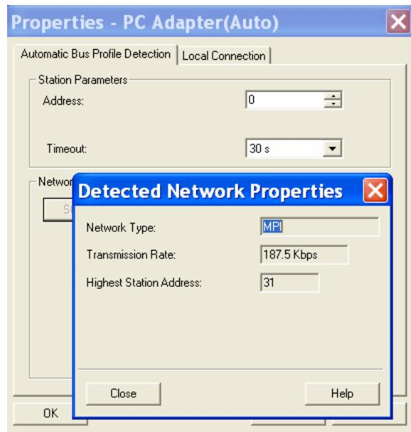
根据检测到的波特率可以按照前面两种方法设置接口建立与 CPU 的通讯或者可以就使用“PC-Adapter(Auto)”方式通讯。
