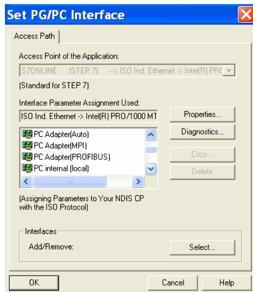
(a) 、如果选择与 **CPU** 相连的是 **MPI** 接口，请选择 **PC Adapter(MPI)**，此时 **S7ONLINE (STEP7) ->** 为 **PC-Adapter(MPI)**，然后点击 **Properties...** 按钮设置 **MPI** 和串口的属性，画面如下：
