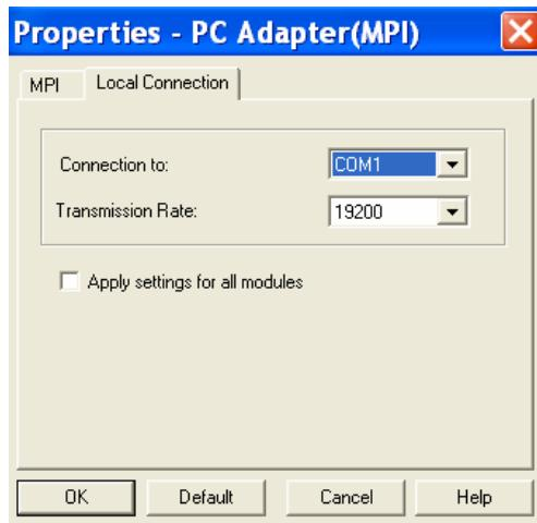
注意此处的串口波特率 Transmission Rate: 19200 必须与 PC-Adapter 上的串口波特率设置一致，如果不一致 Step7 会提示“适配器可能被损坏”的错误信息，同时要注意 PG/PC 的地址不要和 PLC 的地址相同。设置完“Local Connection”串口的属性后点击 Automatic Bus Profile Detection 选项，画面如下：
