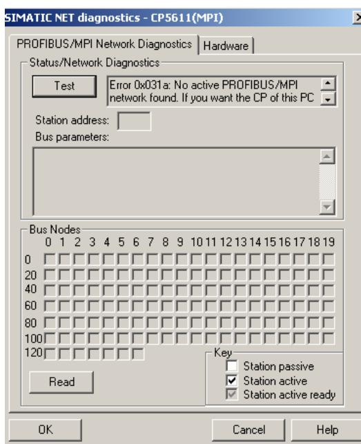
注：如果网络测试显示“Error 0x031a”错误信息，可以在“Set PG/PC Interface ...”中点击 **Properties...** 按钮，然后将 PG/PC 设为唯一的主站，画面如下：
