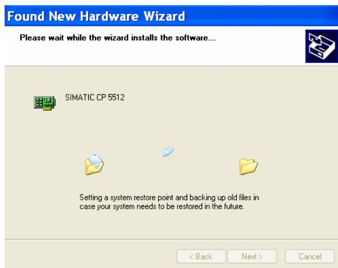
自动安装完成后点击 **Finish**，CP5512 可以正常使用，在 Step7 软件的“Set PG/PC Interface ...”中可以选择相应的 CP5512 接口类型，画面如下：
