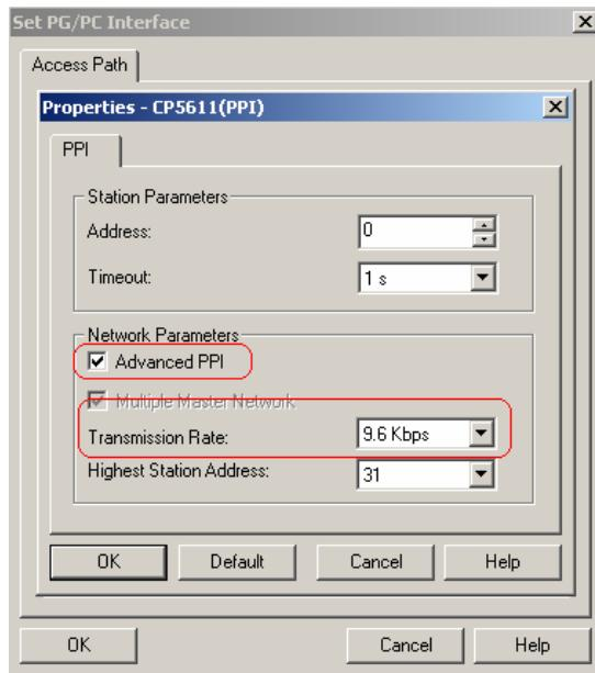
设置 PPI 属性，如果要实现多主站连接，请选中“Advanced PPI”选项，然后选择 PPI 接口的通讯波特率 **Transmission Rate: 9.6 Kbps**，**注意此处的波特率一定要和实际要通讯的 CPU PPI 口实际的波特率相同**，例如如果 CPU PPI 口实际的波特率为 9.6Kbps，而此处设置为 187.5Kbps，则不能建立通讯，会显示错误信息，其它按默认设置，**同时要注意 PG/PC 的地址不要和 PLC 的地址相同**。
