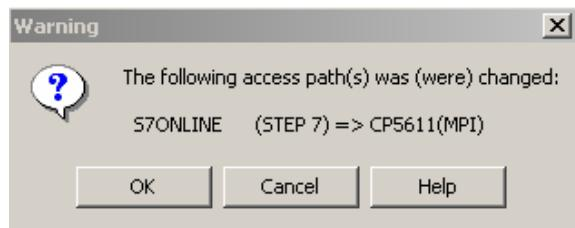
点击 “OK” 完成 PG/PC Interface 的设置，此时可以建立 PC 与 CPU 的通讯，正常通讯时 CP5611 卡的指示灯快闪。
