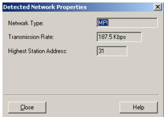
根据检测到的波特率可以按照前面两种方法设置接口建立与 CPU 的通讯或者可以就使用“CP5512(Auto)”方式通讯。
