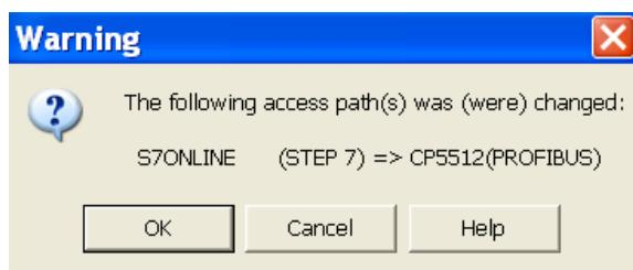
点击“OK”完成 PG/PC Interface 的设置，此时可以建立 PC 与 CPU 的通讯。
