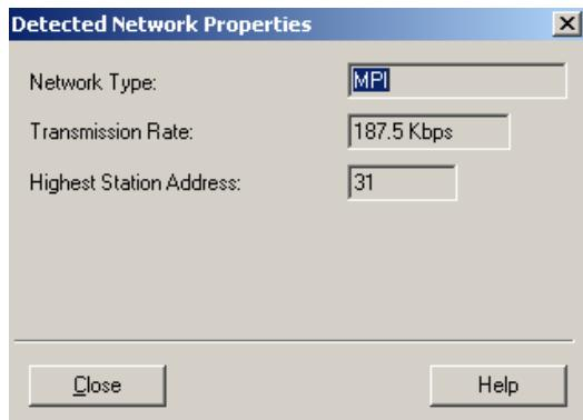
根据检测到的波特率可以按照前面两种方法设置接口建立与 CPU 的通讯或者可以就使用“CP5611(Auto)”方式通讯。
