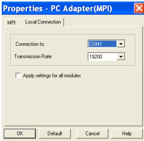
注意此处的串口波特率 **Transmission Rate: 19200** 必须与 PC-Adapter 上的串口波特率设置一致，如果不一致 Step7 会提示“适配器可能被损坏”的错误信息。设置完成后点击 2 次“OK”，Step7 会提示如下信息
