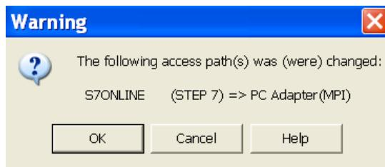
点击“OK”完成 PG/PC Interface 的设置，此时可以建立 PC 与 CPU 的通讯，正常通讯时 PC-Adapter 的 Power 灯常亮，Active 灯快闪。
