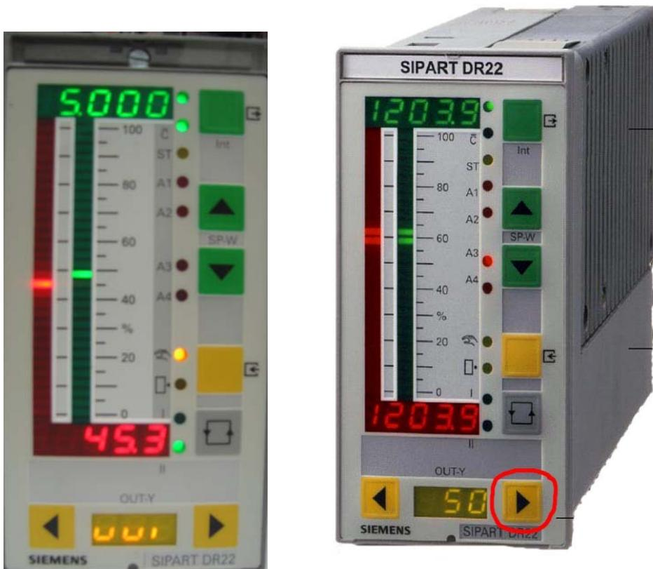
按退出键 2，退出 onPA 在线参数级的组态参数
