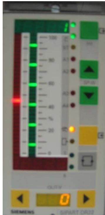
通过 13.1 或 13.2 键选择相应参数，按 6.1 或 6.2 键修改具体参数的大小。此组态开关用来组态控制类型，输出结构，模拟量输入输出等等控制功能，具体参照 DR22 操作手册。
