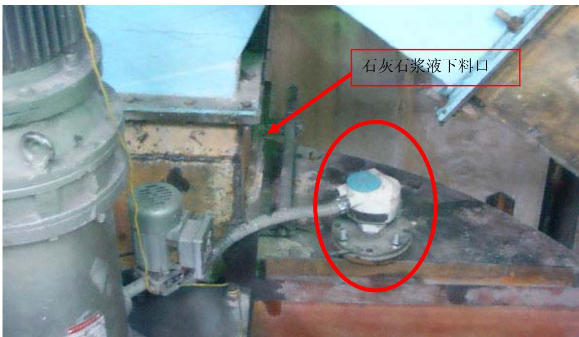
问题描述：物料始终显示 1.14 米左右。且显示失波状态。通过 PDM 软件察看波形图如下：
