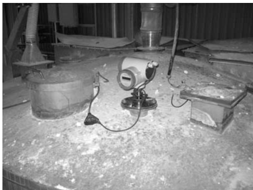
图7 可靠测量树脂粉末料位的 LR460 赢得 Reagens 公司的赞誉
