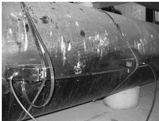
东洋污水 污水进水 DN800 管道，V 法测量
