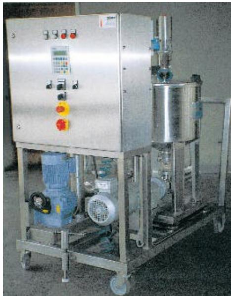
水果冰激凌生产中，原料的不断浮动给德国冰激凌生产商的良好自动化成分配比带来了潜在问题。**SIWAREX称重及批处理装置**和混合喷射器保证了整个水果冰激凌产品的高质量。
