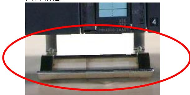
3. 屏蔽连接端子，每包两个，适合线径为 4 到 13mm 的。适合传感器电缆，RS485 和 RS232 接口。
