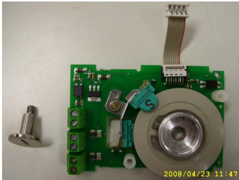
(1) 通过上图左侧的金属螺帽将 SIA 模块与阀门定位器的黑色拨轮连接在一起
