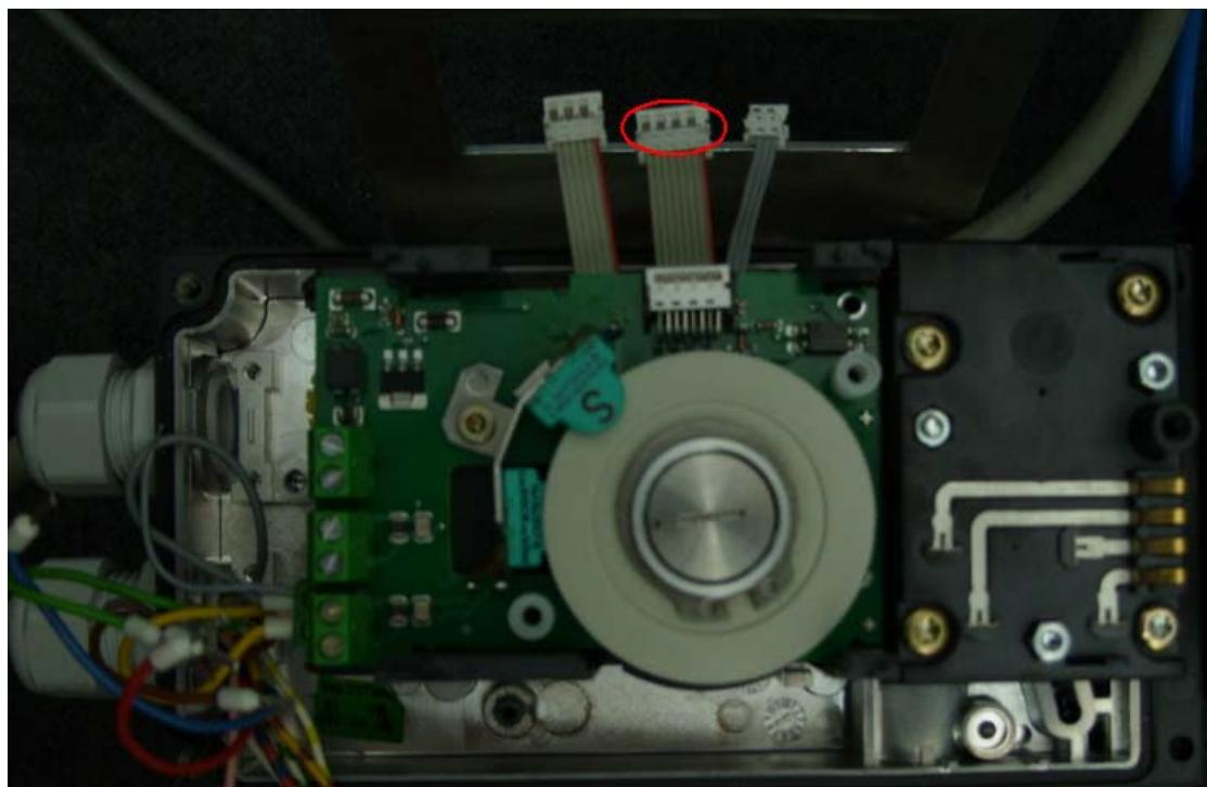
(2) 通过扁平电缆将 SIA 模块和主板连接
