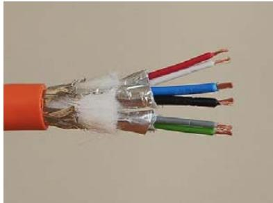
2. 蓝色外皮电缆, 线径是 Li2Y 1\*2\*0.75 ST + 2\* (2\*0.34ST) -CY, 外径 10.8mm。
