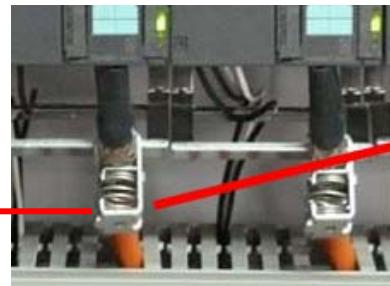
5. S7 安装导轨，用于安装 SIWAREX 模块或 CPU 等 S7 模块。根据不同长度，有不同
