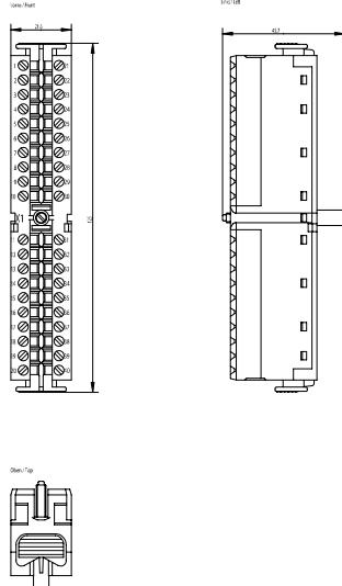
2. 40 针前连接器，带弹簧的接线端子。每个 SIWAREX FTA 模块均需要一个，否则无法接线。与螺钉端子二选一
