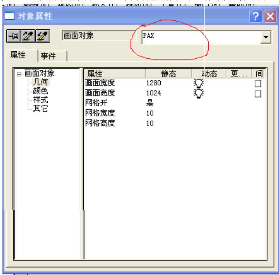
8. 在 WINCC 项目的电脑属性的启动菜单里把全局脚本启动起来。设置完成，启动 WINCC 测试你的项目。
