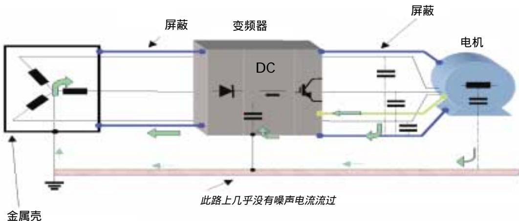
为此，无线电干扰抑制滤波器应安装在变频器的输入端，这样以来流回电源的噪声电流会大大减少。
