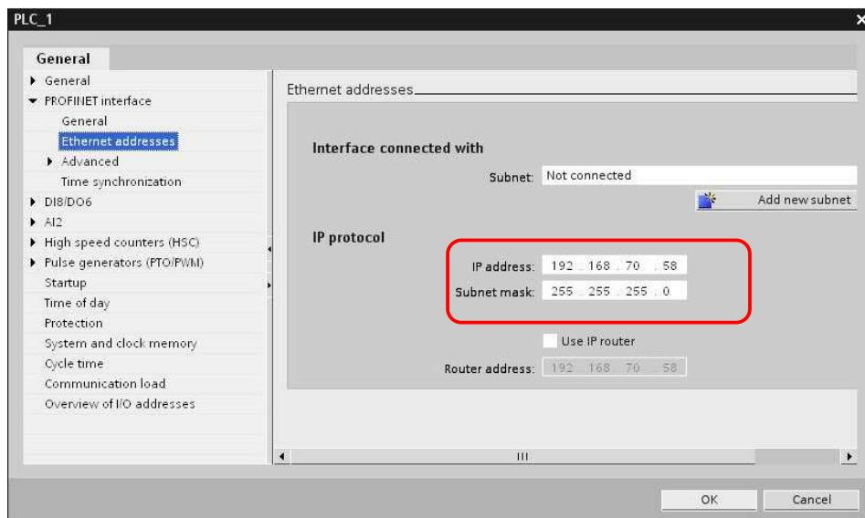
将 Step7 组态下载到 PLC 中。确认从 PVSS 站上可以 ping 通 PLC 的 IP。
