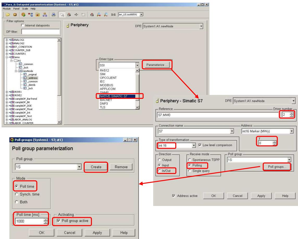
15) 验证通信连接状态：在 Step7 的在线变量表中强制 MW0 为任意值，应该可以在 Para 中看到结果：
