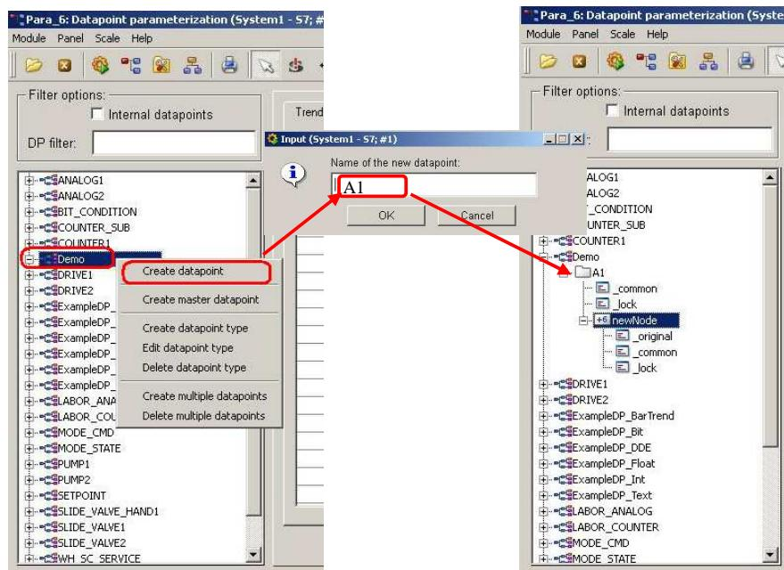
13) 为数据点 A1.newNode 设置变量地址：右键单击“newNode”在弹出菜单中选择“Insert config”->“Periphery address”。如下图所示：
