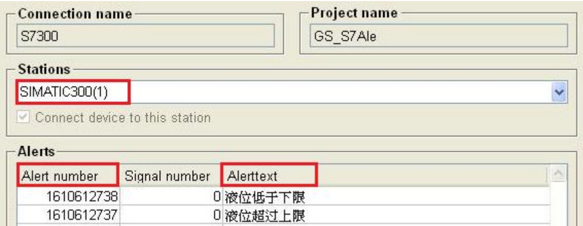
图 2： S7 报警参数对话框
