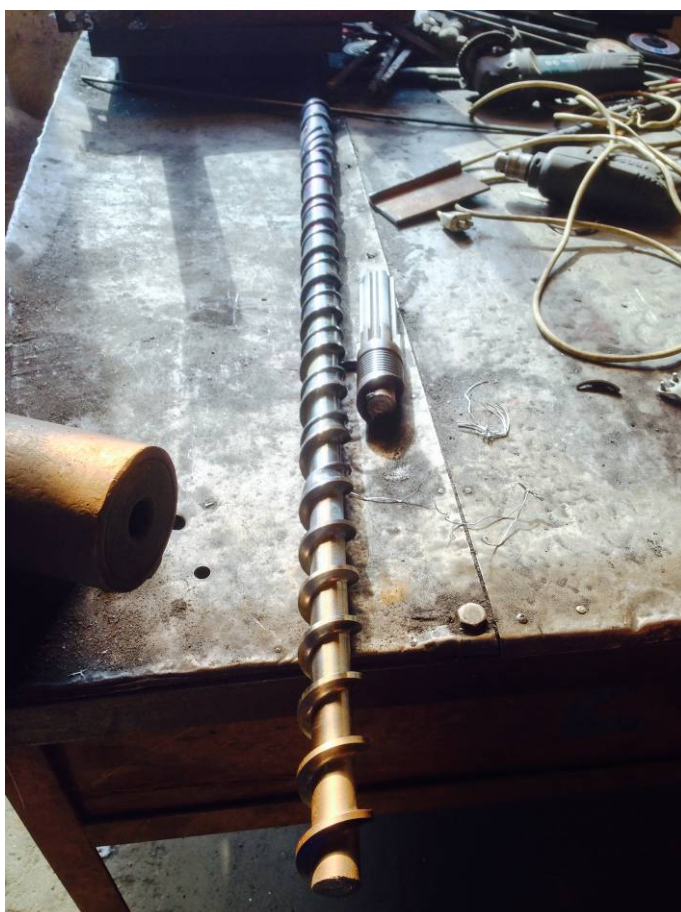
图 2：设备已断成两截，长度分别为 210mm 和 1130mm
