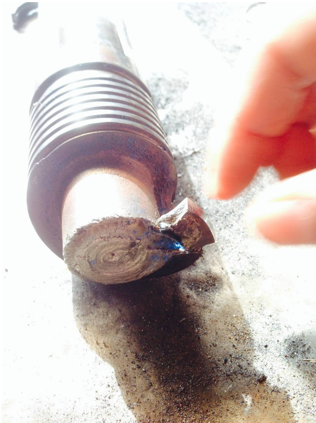
图 3：螺杆螺棱上掉了一小碎铁块
