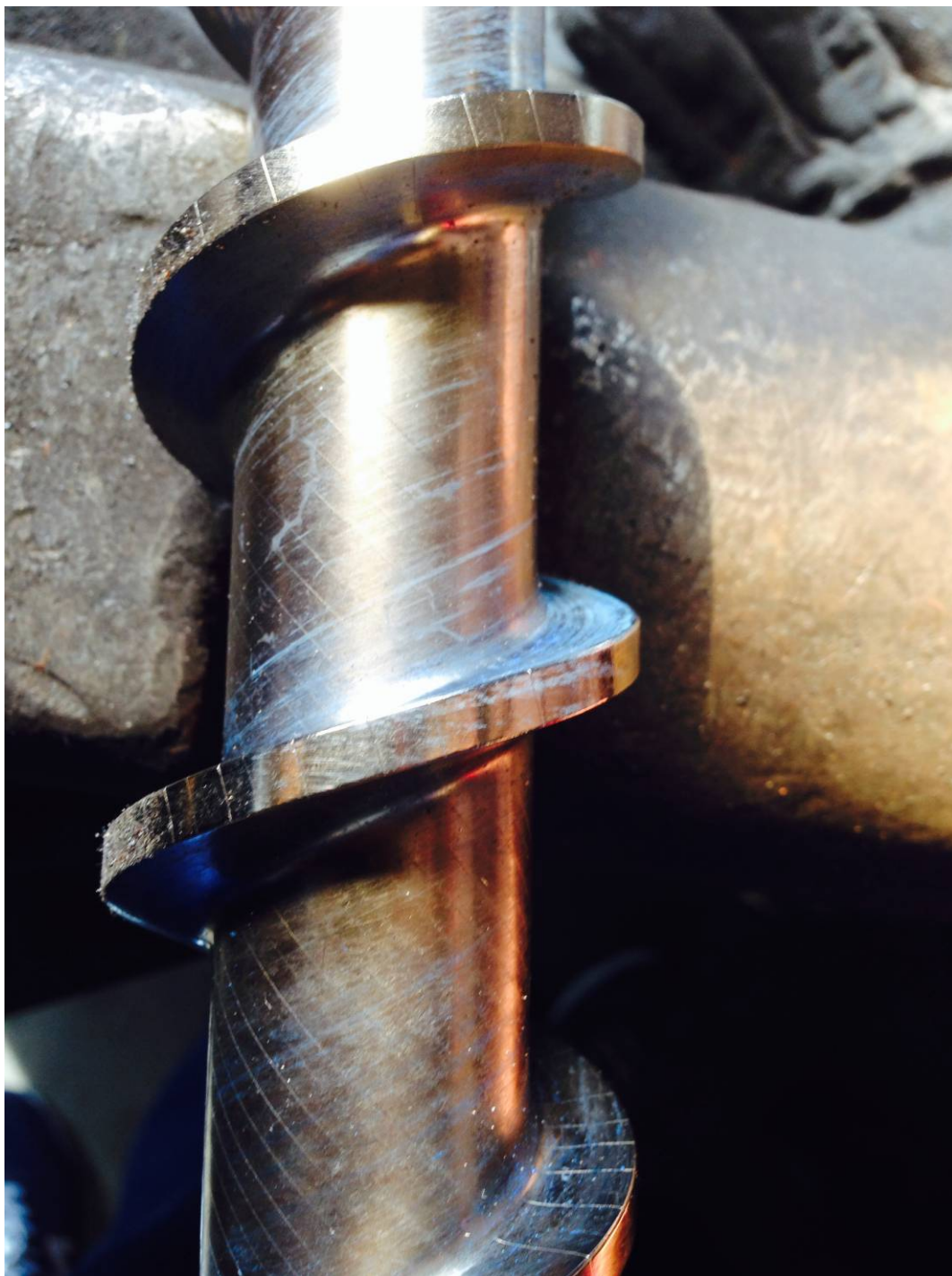
图 5：螺杆上有裂纹（小碎铁块上也有裂纹）
