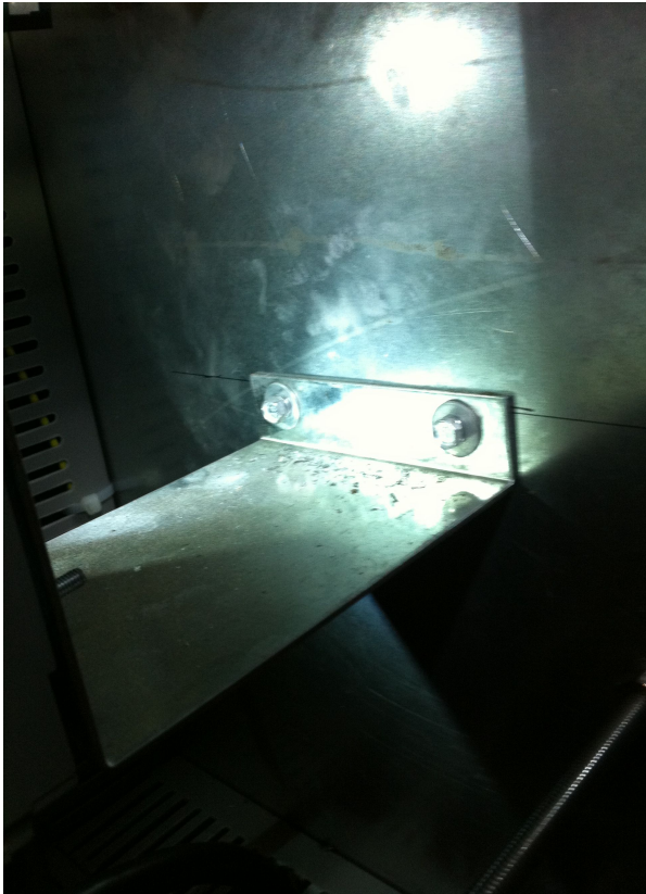
事故柜内残存的铁屑
