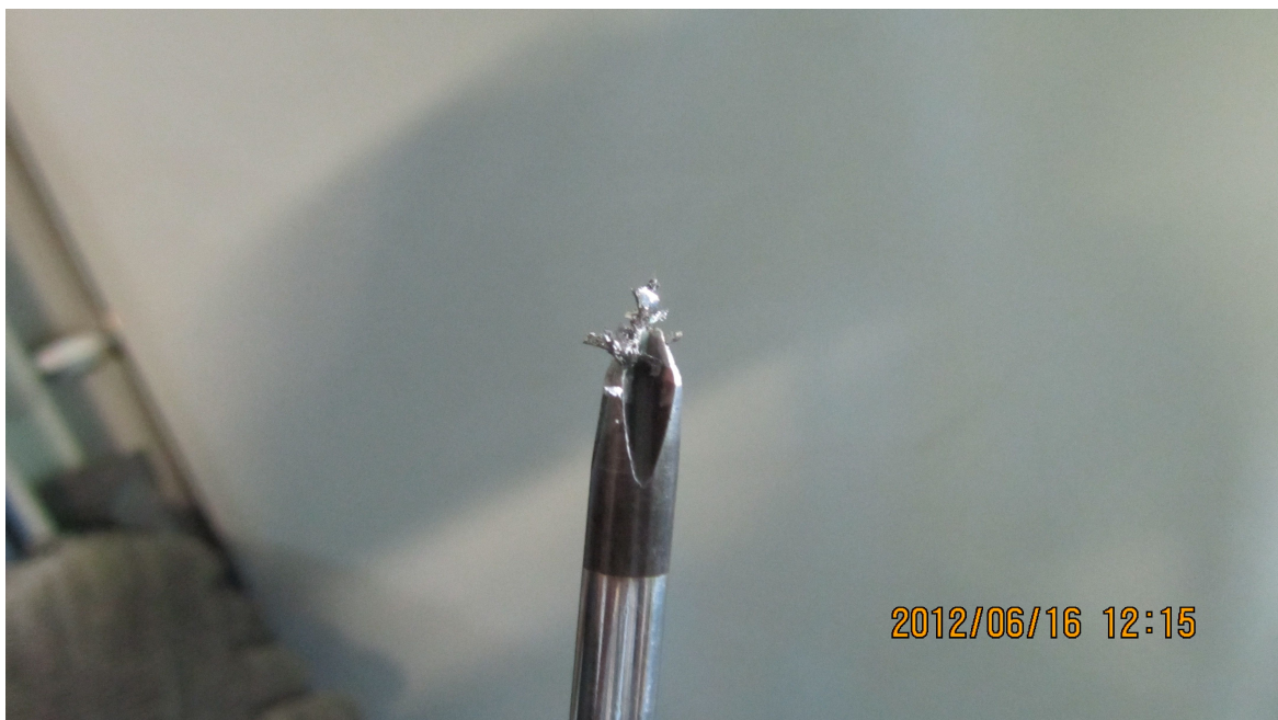
磁性改锥在拆卸空开时吸附到的大量铁屑
