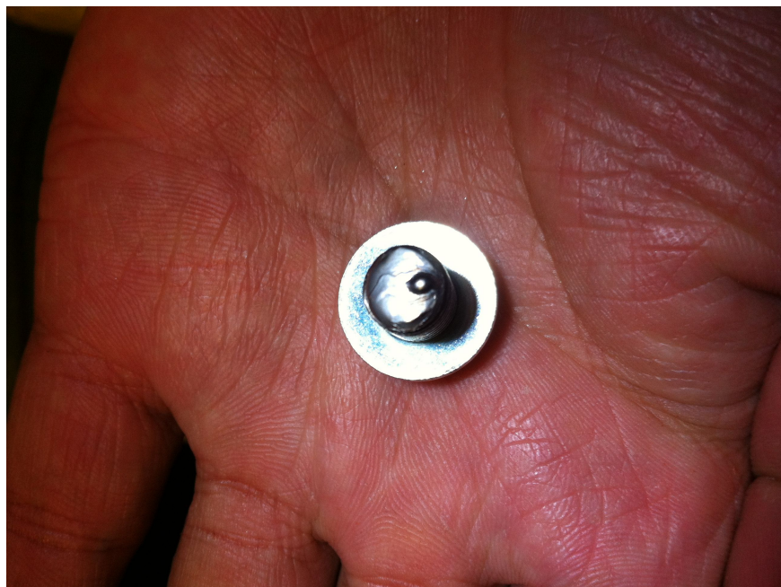
熔化在螺钉上的铁屑 1
