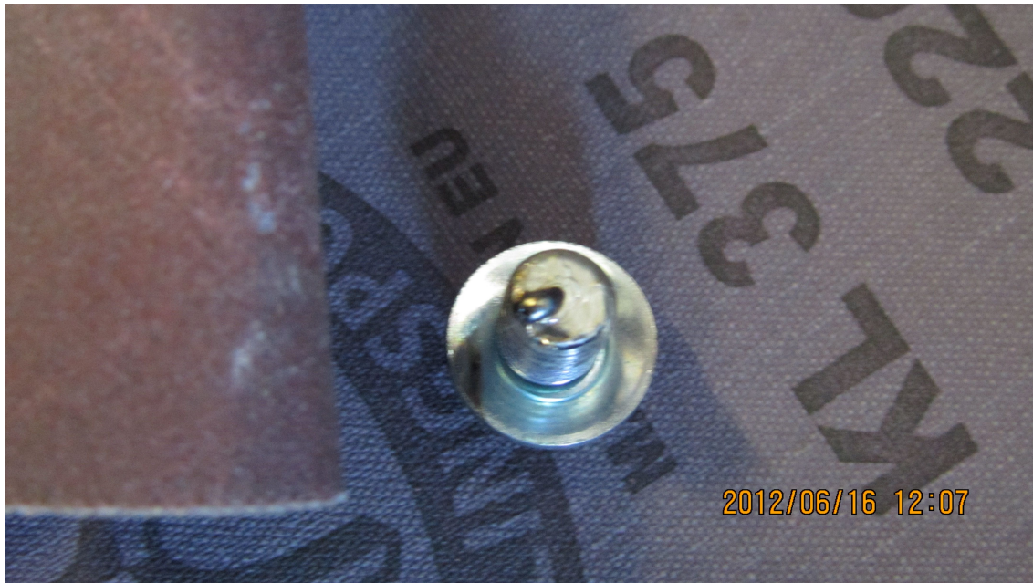
熔化在螺钉上的铁屑 2
