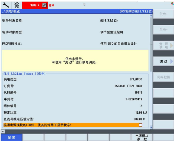
图 5-0. 供电模块未配置
