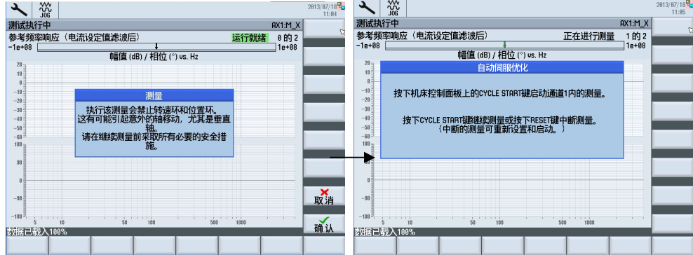
图 13-20 电流环测量过程
